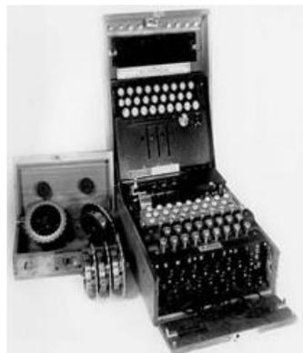
Figura 5: Máquina Enigma de 3 rotores
