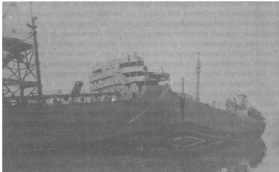
Figura 4.2a Ejemplo de falla. Buque tanque T-2 "S.S. Schenectady", partido en dos en el muelle para la instalación final de accesorios, Portland, Oregon. 16 de enero de 1943. (Cortesía de Ship Structures Com-mitee , U.S. Government.)
