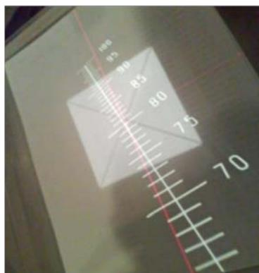
**Figura 3.14. Medio de iluminación para definir el campo 10cm x 10cm a una distancia de 80 cm en el equipo de Cobalto  $^{60}\text{Co}$**
