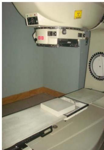
**Figura 3.13 Arreglo para radiar los dosímetros con  $^{60}\text{Co}$**
