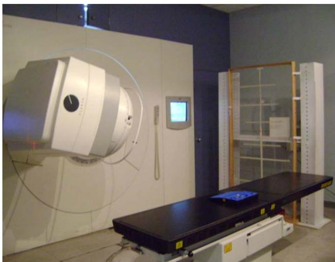
*Figura 3.17. Arreglo experimental: acelerador, base de madera y acrílico.*
