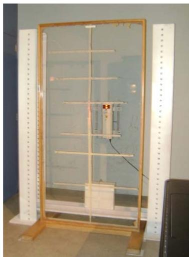
Figura 3.3 Barrera acrílico colocado en la base de madera
