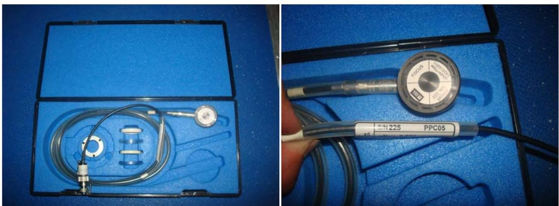
**Figura 3.12. Cámara de ionización PPC05 utilizadas en la verificación de la calidad del haz.**
