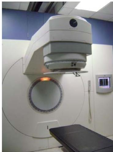
**Figura 3.9. Acelerador Lineal Elekta SL-15.**
