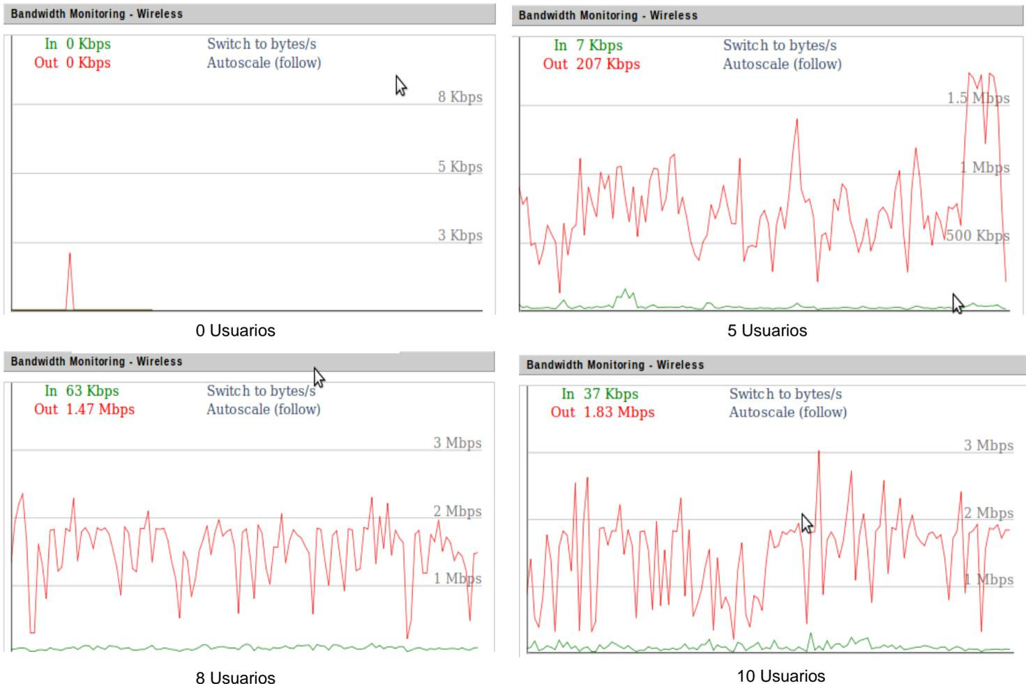
FIGURA 5. 9 Monitoreo de Ancho de Banda de la red inalámbrica con 0, 5, 8, 10 usuarios
