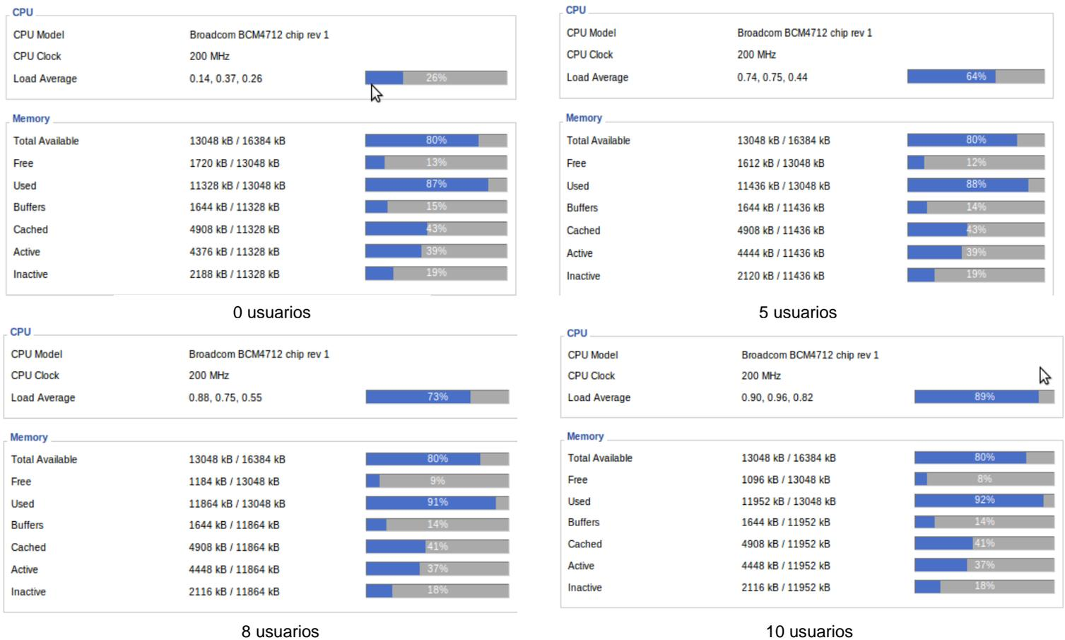
**FIGURA 5. 7** Monitoreo del Rendimiento del CPU y Memoria del AP con una carga de 0, 5 ,8 ,10 usuarios
