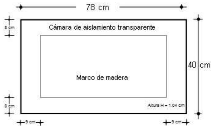
(a) Colocación del marco de madera dentro de la cámara de aislamiento transparente utilizados en las pruebas de imbibición.
