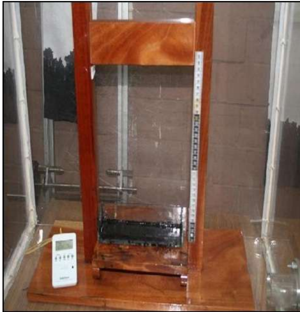
Figura 4.2 Montaje de mecanismos utilizados en las pruebas de imbibición.
