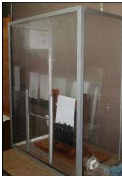
Figura 4.4 Vista esquemática de la prueba de imbibición.
