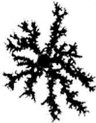
Figura 2.8 Digitación viscosa característica generada por la inyección de agua en una celda Hele-Shaw radial llenada con una solución polimérica más viscosa [2.12].
