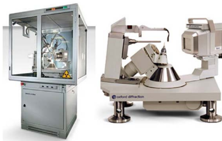
Figura 2.6 Difractor XCalibur E Oxford Diffraction (izquierda) y goniómetro de 4 círculos con geometría Kappa (derecha).
