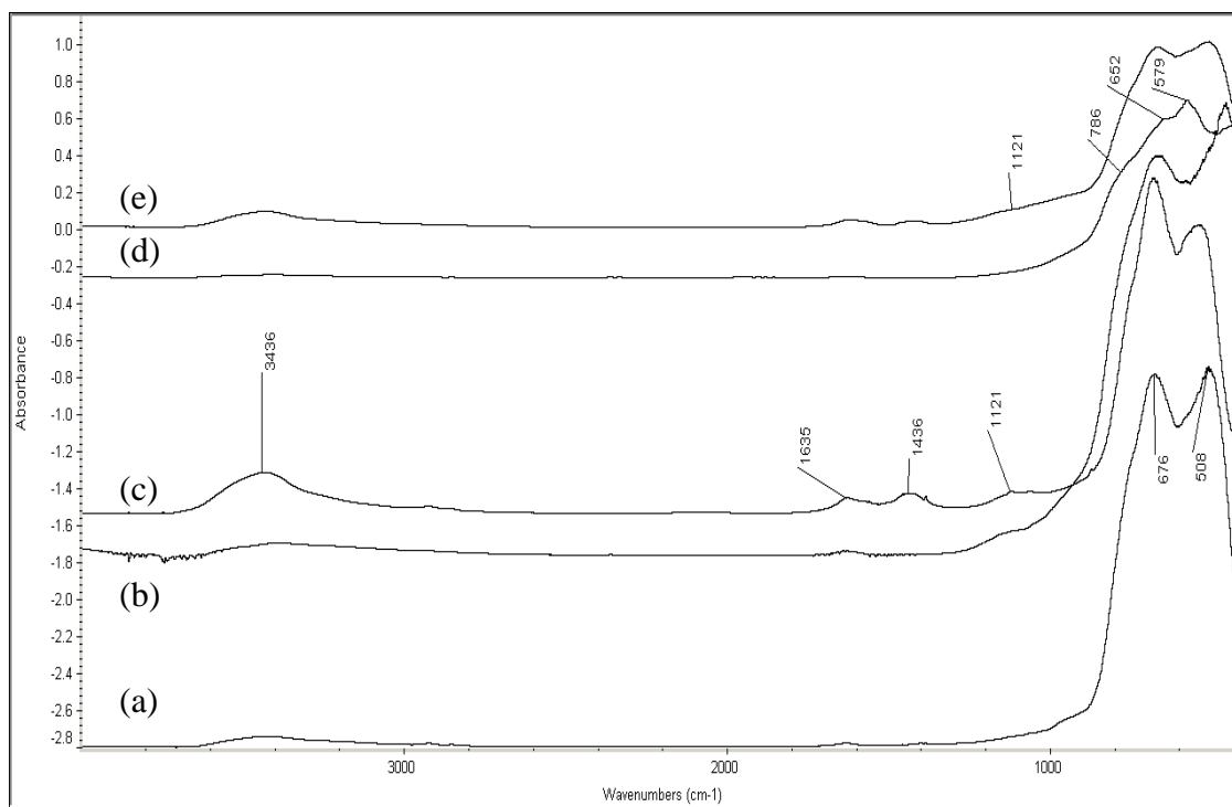
Figura 4.1.1-2 Espectros FT-IR de: \text{TiO}_2 (a), \text{TiO}_2\text{-H}_2\text{SO}_4 (b), \text{TiO}_2\text{-(NH}_4)_2\text{SO}_4 (c), \text{TiO}_2\text{-PO}_4^{3-} (d) y \text{TiO}_2\text{-Cl}^- (e)
