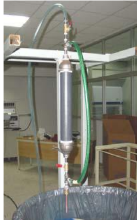
Fig. 7.3 Maquina Prototipo Etapa 1, Exploración. Boquilla utilizada: cobre.
