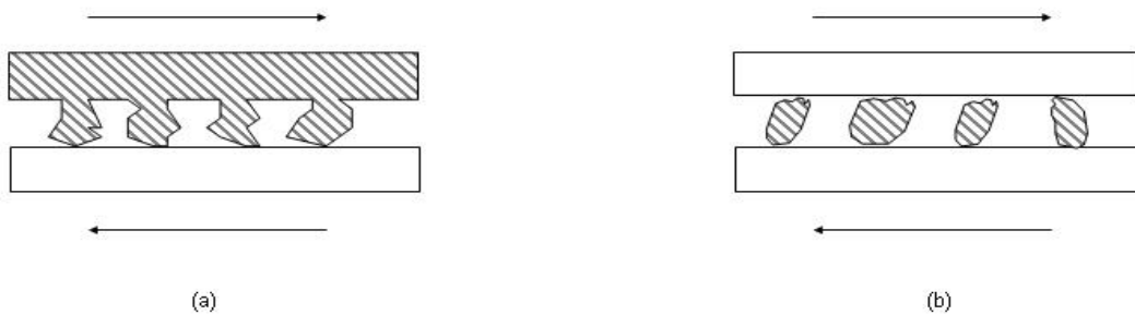
Fig. 3.1 Tipos de Abrasión. (a) Abrasión de dos cuerpos y (b) abrasión de tres cuerpos [12].
