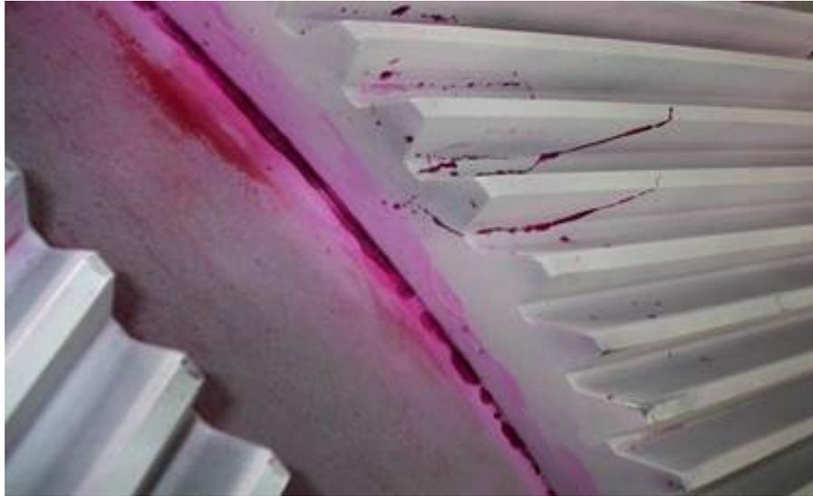
*Figura 4.2. Ensayo por líquidos penetrante [186]*
