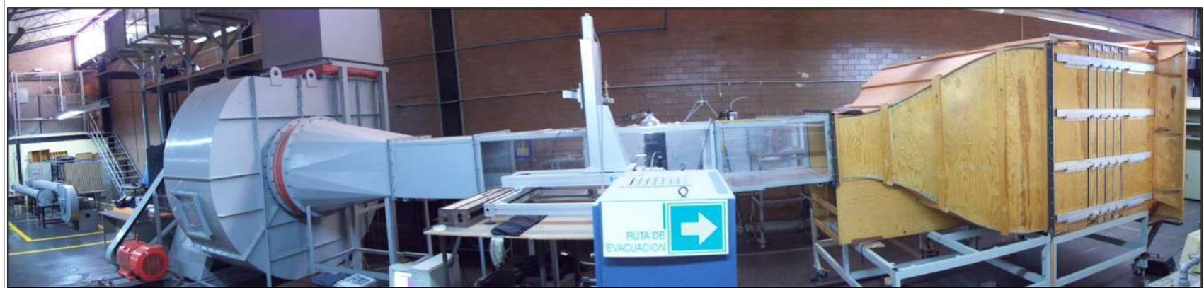
a) Túnel de viento de velocidad baja del LABINTHAP.
