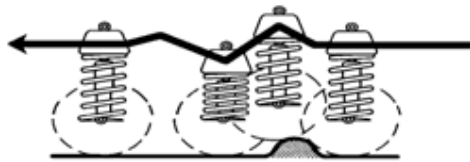
Fig.9 Como actúan los resortes y amortiguadores en buen estado.
