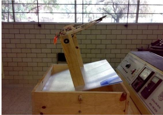
**Figura 35. Alteración del Angulo de Ataque al Avión Inducido por la Plataforma. (-)**
