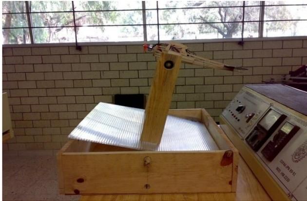
**Figura 33. Alteración del Angulo de Ataque al Avión Inducido por la Plataforma. (+)**
