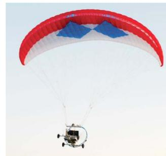
**Figura 5. Paracaídas autónomo**
