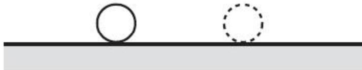
**Figura 7. Cuerpo Neutralmente Estable o en Estado de Reposo**
