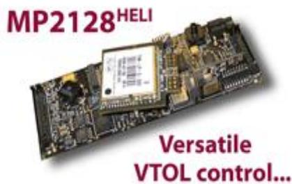
De acuerdo con la tecnología del piloto automático por micropilot este puede usarse para vuelos de ala fija o ala rotativa. Cuenta con un sensor ultrasónico, un modulo de GPS y un compas, así mismo puede emplearse para aterrizajes y despegues autónomos.
