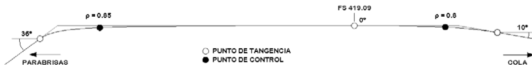
Figura 4.5 Definición del perfil del techo del Dash-3 mediante curvas cónicas
