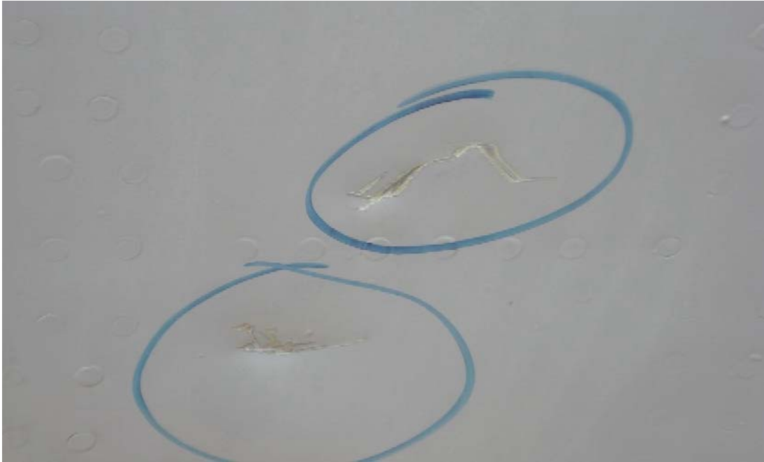
Figura 4. Melladuras localizadas en la estación 360RH del fuselaje.
