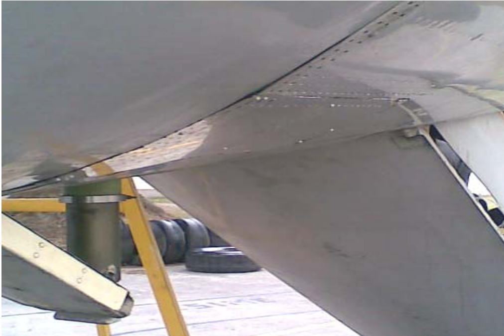
Figura F. Reparación estructural del daño con fines didácticos.
