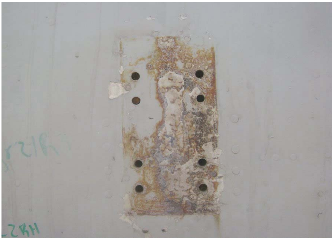
Figura 3. Indicios de corrosión, localizada en la estación 348.2RH del fuselaje.
