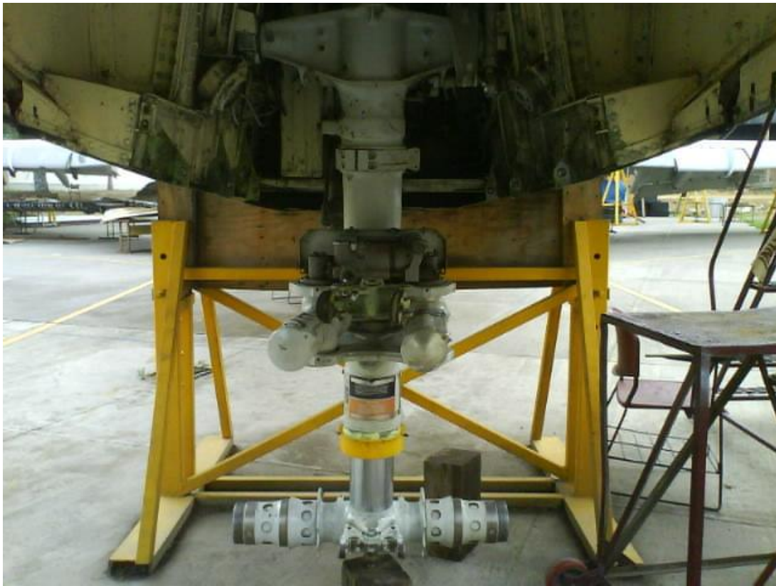
Imagen No. 39 - Ensamblaje y montaje total del tren de aterrizaje de nariz
