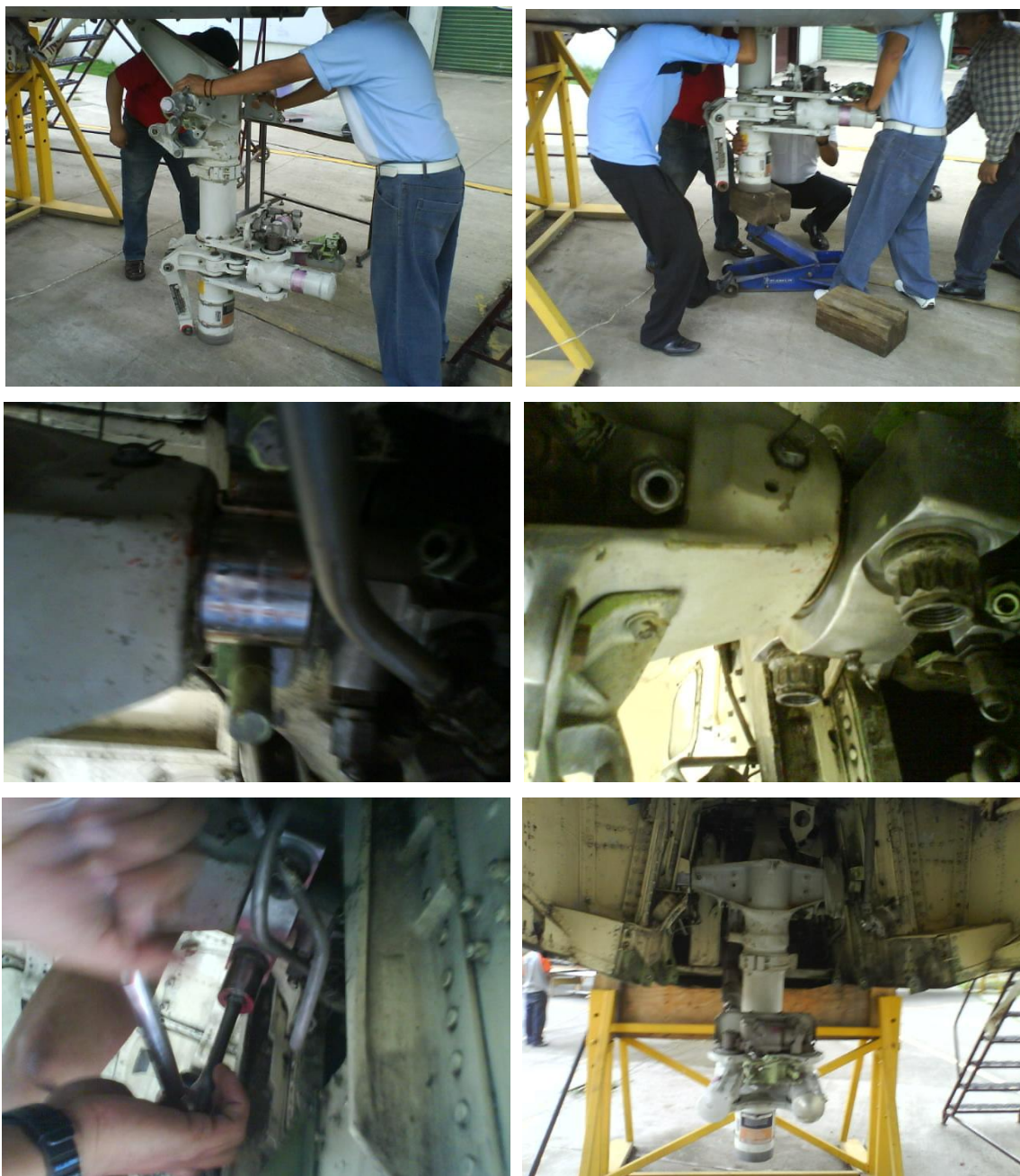
Imagen No. 34 - Instalación del cilindro exterior
