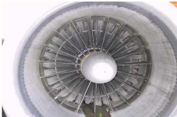
**Figura 61.-** Se aprecia la sección del compresor con de agua y diversos objetos.
