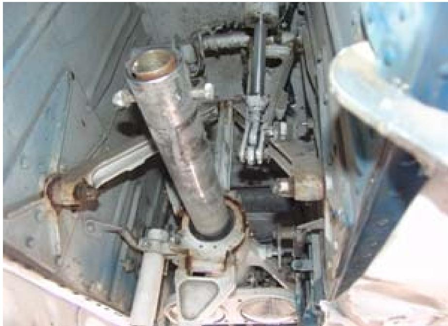
**Figura 45.-** Vista del interior de la pierna de nariz donde se aprecia el daño de esta y del sistema de extensión.
