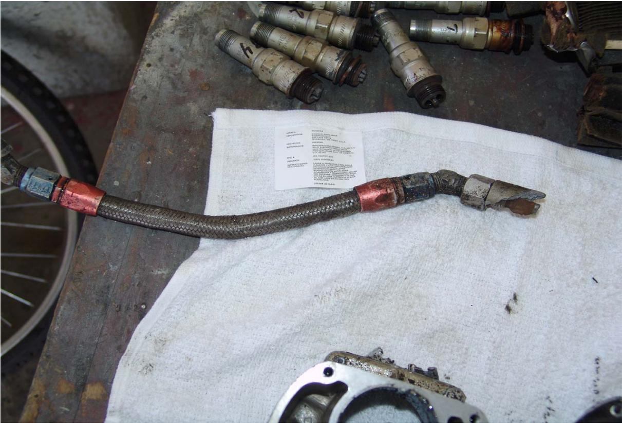
25.- VISTA GENERAL DE UNA DE LAS MANGERAS DE COMBUSTIBLE AL MOTOR, DONDE SE APRECIA SIN APARENTES DAÑOS.
