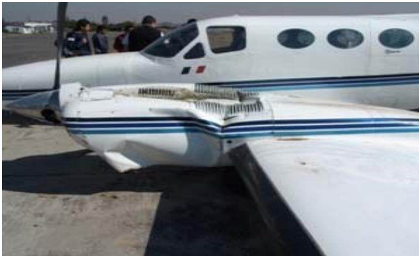
**Figura 47.-** Condición que presenta la cubierta del motor después de un accidente, como se aprecian los daños por diversos impactos.
