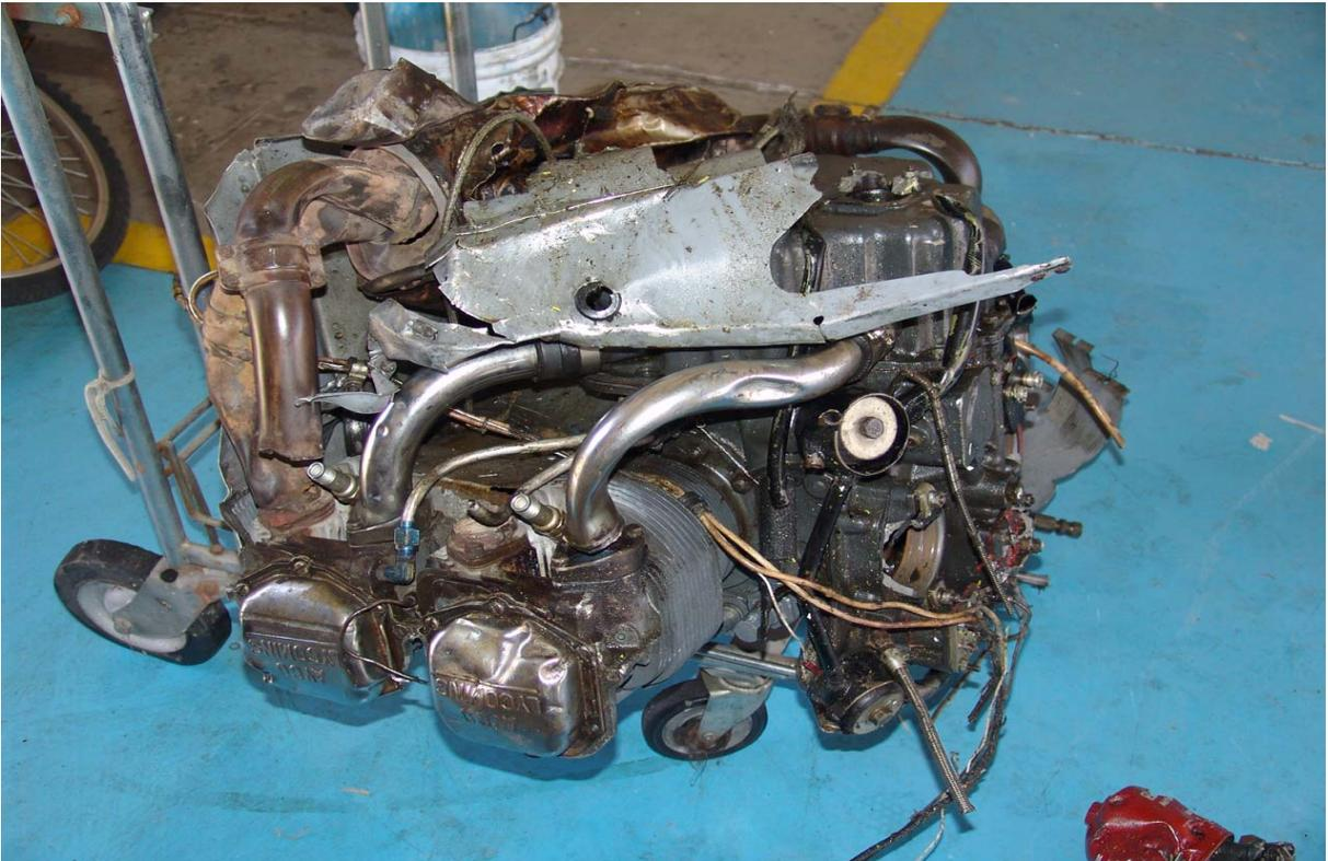
3.- VISTA LATERAL DERECHA DEL MOTOR, APRECIANDOSE ALGUNOS DAÑOS POR IMPACTO Y LAS CONDICIONES GENERALES DE ESTE.
