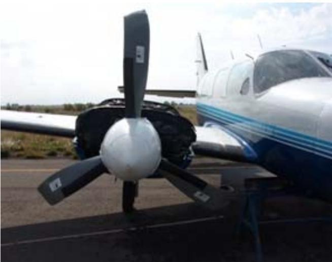
**Figura 29.-** Se muestra el daño en las palas de la hélice, con los dobles por impactar el terreno con cierta potencia, sin llegar a ser la máxima.
