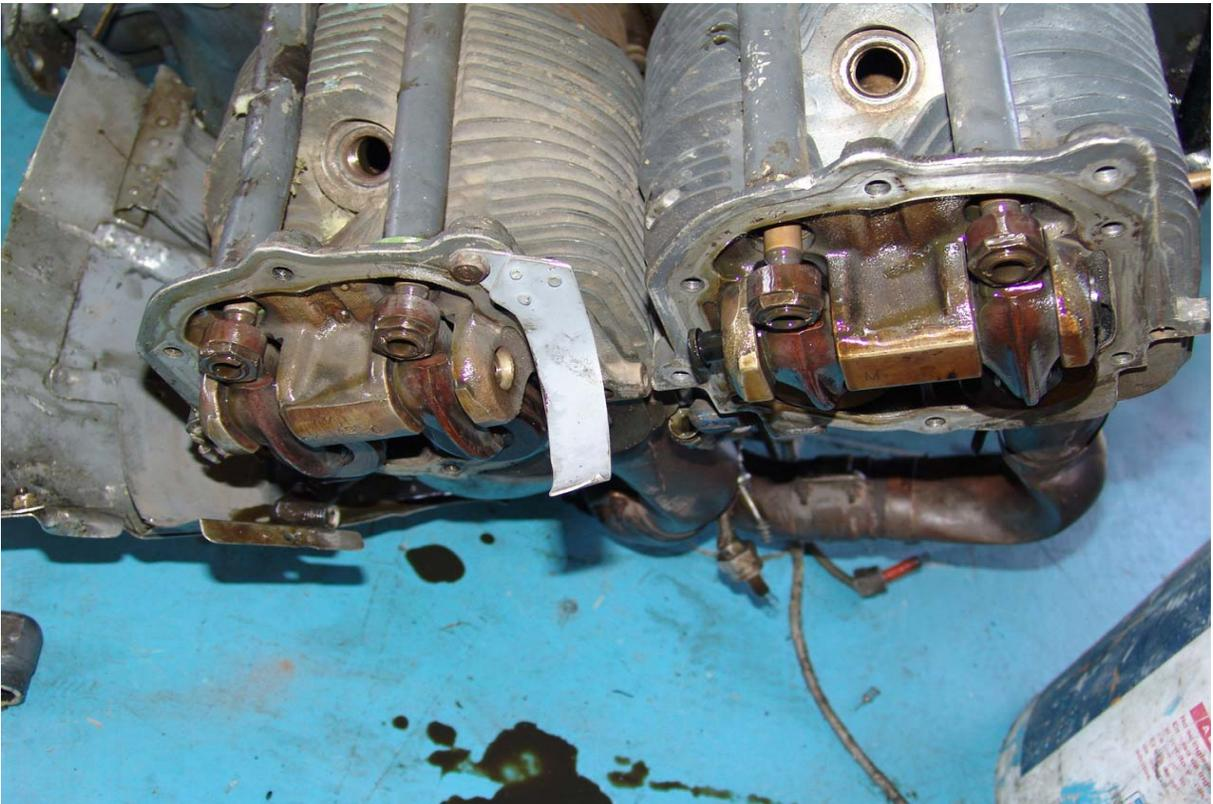
18.- ACERCAMIENTO A LOS BALANCINES DE UNOS DE LOS CILINDROS APRECIANDOSE EN APARENTE BUEN ESTADO.
