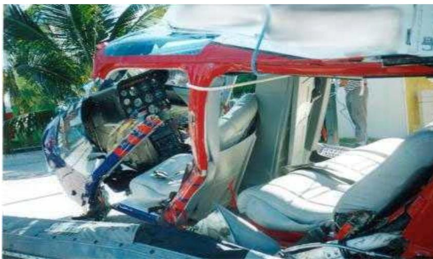
**Figura 16.-** Caso de un helicóptero desplomado donde se aprecia el daño en el cuerpo básico.
