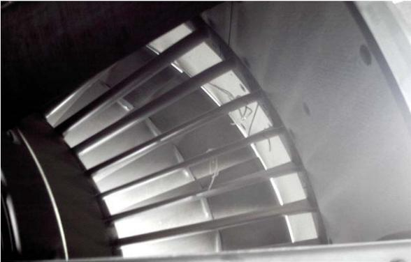
**Figura 63.-** Imagen donde se muestra cuando ingesta unos cables, los cuales se atoran en los alabes estatores del fan, sin causar mayores daños al motor.
