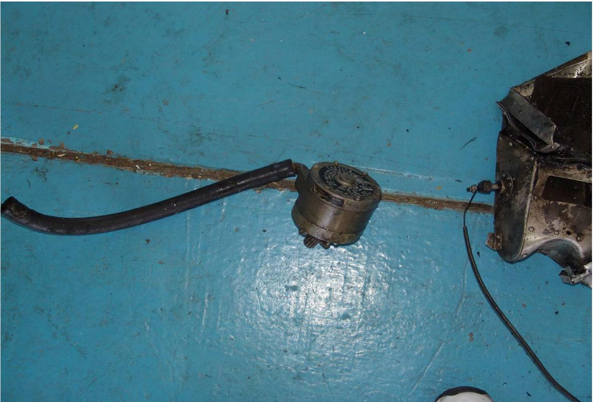
12.- VISTA DE UNOS DE LOS DUCTOS DEL SISTEMA DE COMBUSTIBLE, DONDE SE APRECIA QUE SE DESPRENDIO DE SU POSICIÓN.
