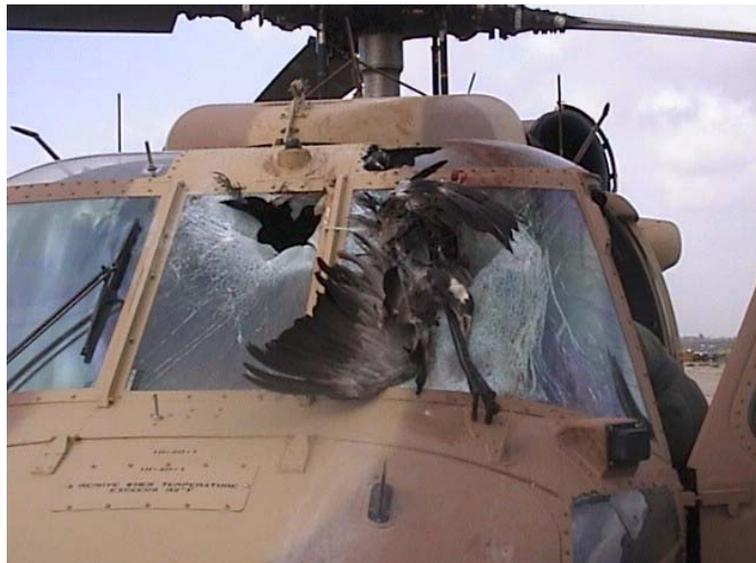
**Figura 74-** En este caso a pesar de ser un ave mediana el impacto es de lleno contra el parabrisas del helicóptero.
