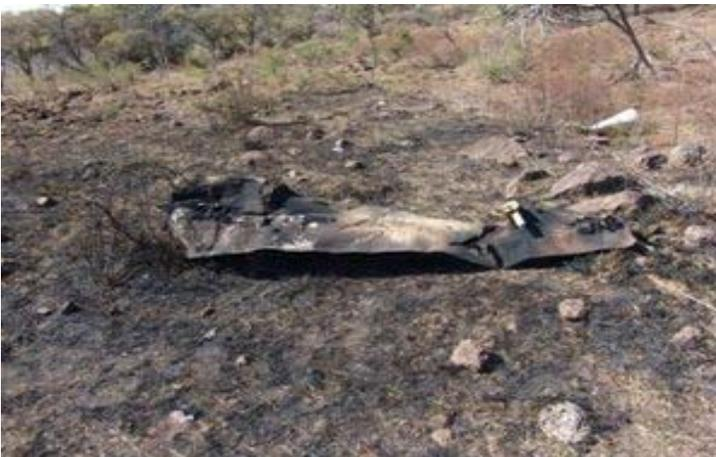
**Figura 42.- Destrucción en el ala de un jet pequeño, por impacto contra el terreno con velocidad.**
