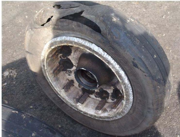
**Figura 65-** Daño en la llanta (masa y neumático) por falla en el sistema antiderrapante
