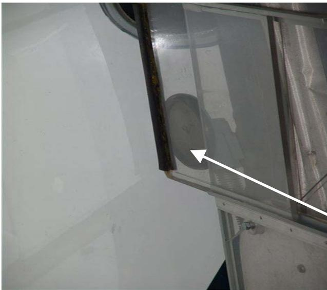
**Figura 56.-** La parte mas crítica de los pasillos telescópicos, es la rueda del sistema de autonivelación, ya que era girada dicha rueda por personas ajenas, es por lo que se le puso la mica de protección que se aprecia, ya que obstruían el movimiento de esta o la movían, mientras los pasajeros subían y bajaban de la aeronave, provocando que trabajarán los amortiguadores, originando daños a esta.
