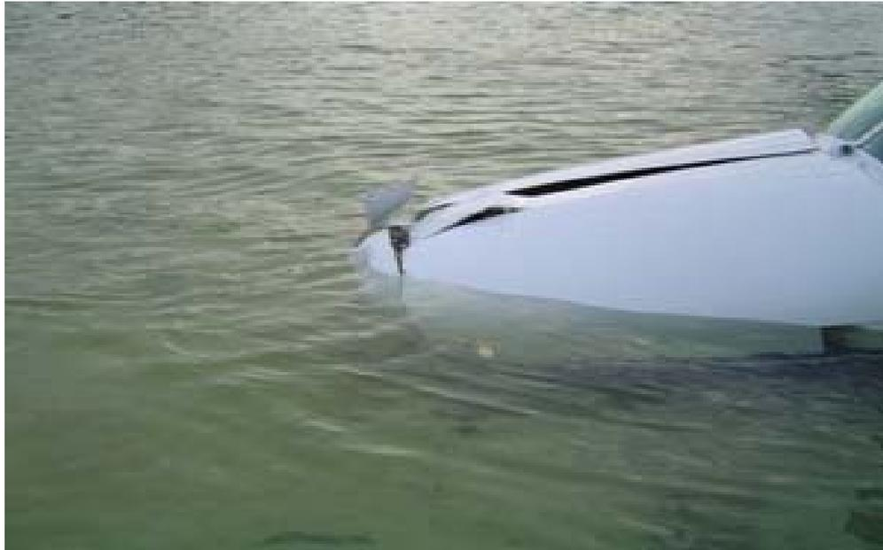
**Figura 34.-** Se muestra una aeronave que por una omisión en el rompimiento de planeo, realizo un aterrizaje corto cayendo en el agua.
