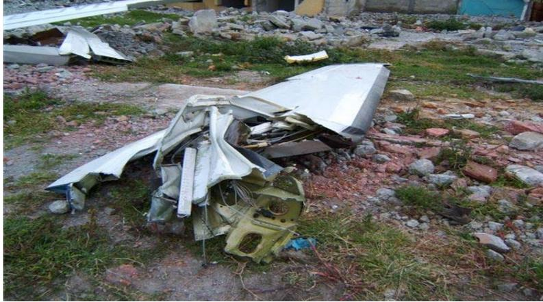
**Figura 17.-** Se muestra las partes de una semi ala de una aeronave expuesta a esfuerzos superiores a sus límites de diseño.
