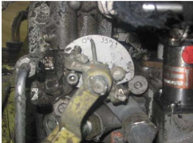
**Figura 54.-** El indicador de potencia de ambos motores, se apreciaron en bajas RPM's, lo que podría confirmar que la aeronave se desplazaba en a baja velocidad
