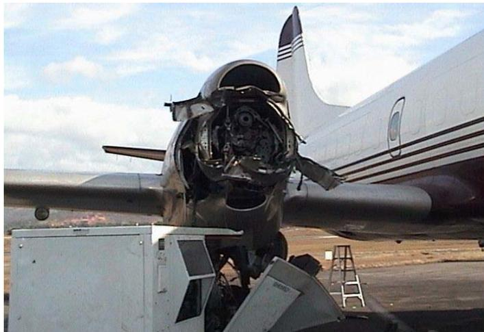
**Figura 58.-** Impacto de una hélice contra un objeto situado en la plataforma.
