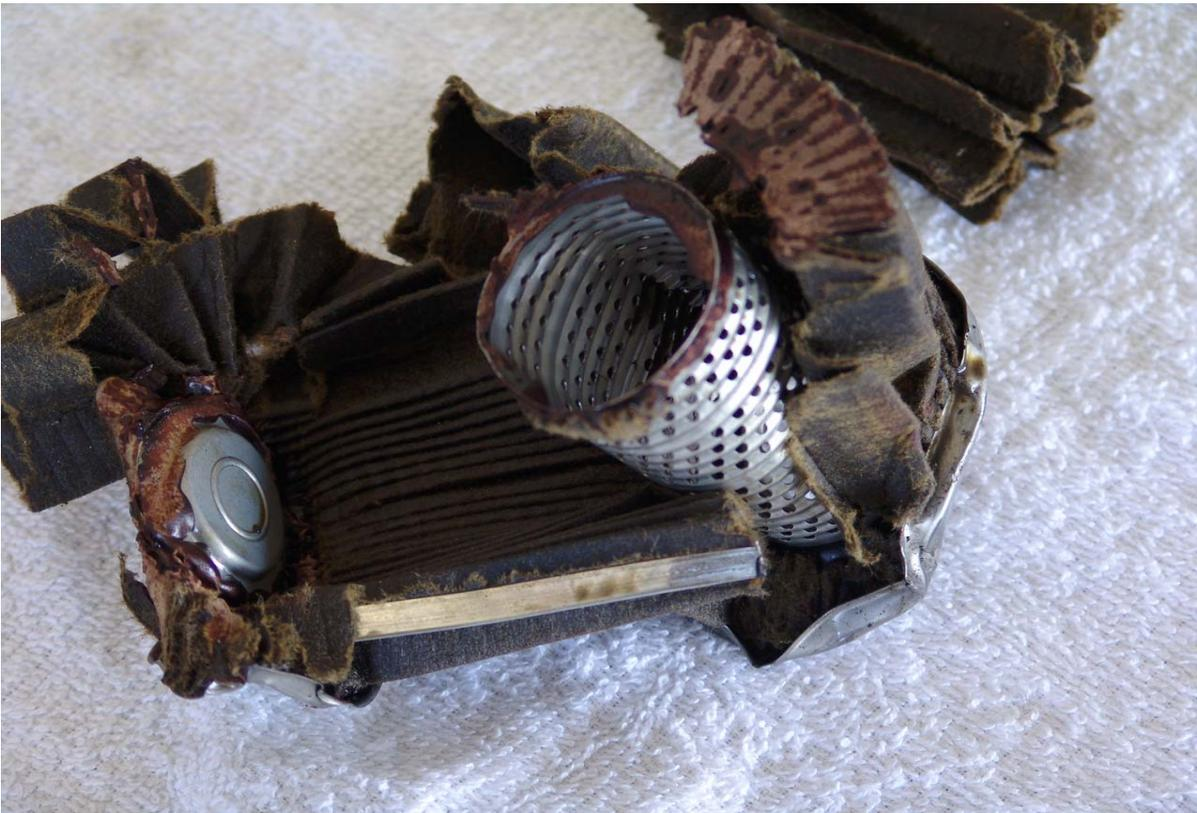
28.- OTRA VISTA DEL FILTRO DE ACEITE DEL MOTOR, DONDE SE APRECIA SIN RESIDUOS SÓLIDOS.
