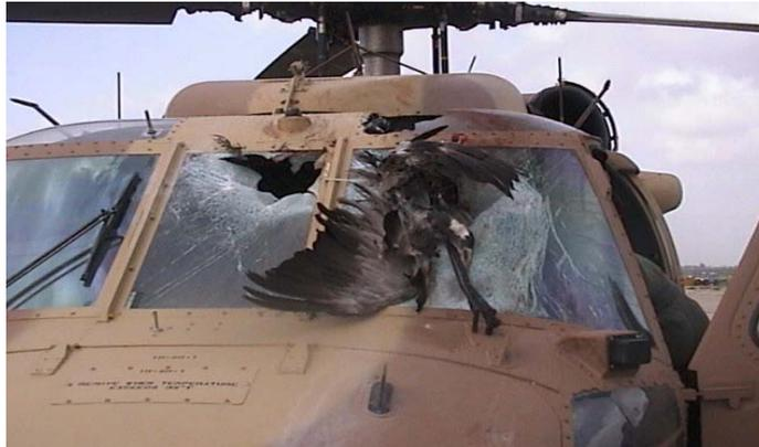
**Figura 12.-** Caso típico de impacto de un ave contra el parabrisas de un helicóptero, ya que estos no operan a grandes altitudes.
