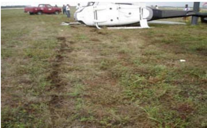
**Figura 24.-** Se aprecia como dejo las huellas los skid del tren de aterrizaje del helicóptero, en el terreno durante una práctica volcandose posteriormente.
