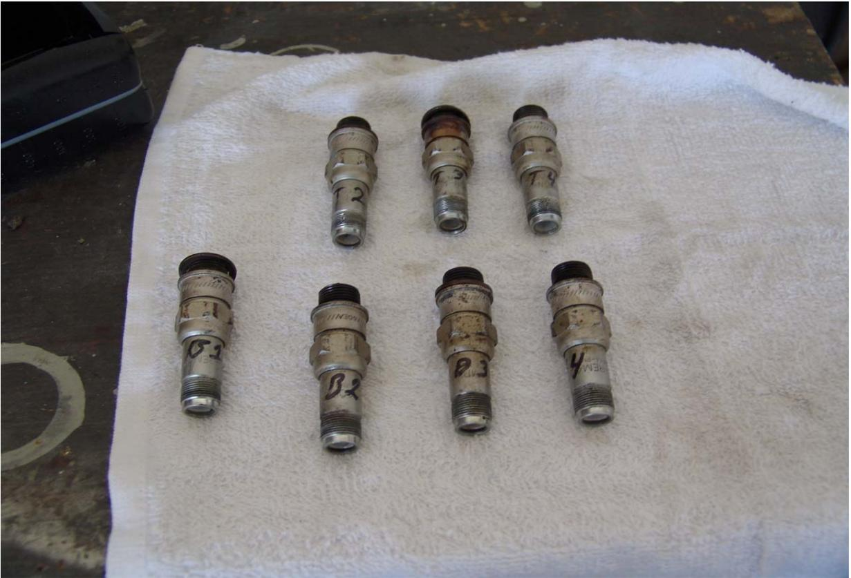
13.- VISTA GENERAL DE LAS CONDICIONES DE LAS BIJUAS DEL MOTOR, APRECIANDOSE QUE FALTA UNA, LA CUAL SE FRACTURO.
