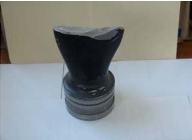
**Figura 32.-** Parte de una pala de una hélice, que se desprendió por fatiga del material, en algunos casos se ha visto que el desprendimiento de una pala ha ocasionado una severa vibración, existen registrados casos, en los que la aeronave por no realizar un aterrizaje inmediato o de emergencia, entra en resonancia, destruyendo la aeronave en pleno vuelo.
