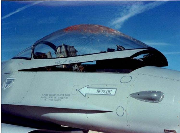
**Figura 73-** Se aprecia como un ave aparentemente mediana impacta con la parte superior del domo de la cabina del piloto.
