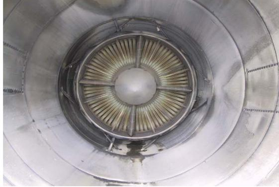
**Figura 62.-** Como complemento de la foto anterior, se aprecia como paso las impurezas por toda la sección del motor hasta salir por la tobera.
