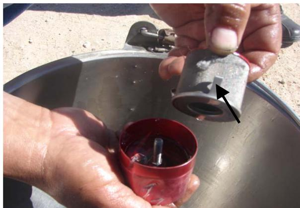
**Figura 60.-** Se aprecia el momento en que se abre el filtro de combustible y se ve impurezas en este lo que no permite el paso de combustible.
