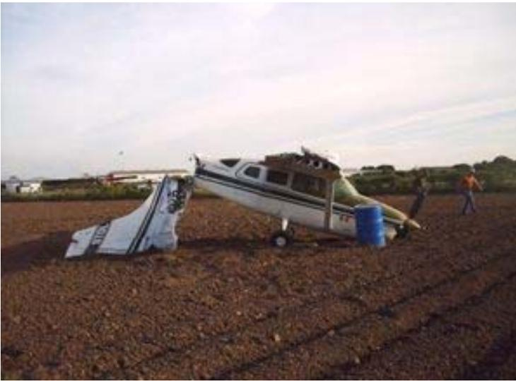
**Figura 46.- caso en el que se muestra el típico daño en el empenaje en un accidente de una aeronave, aterrizaje brusco con pérdida de control.**
