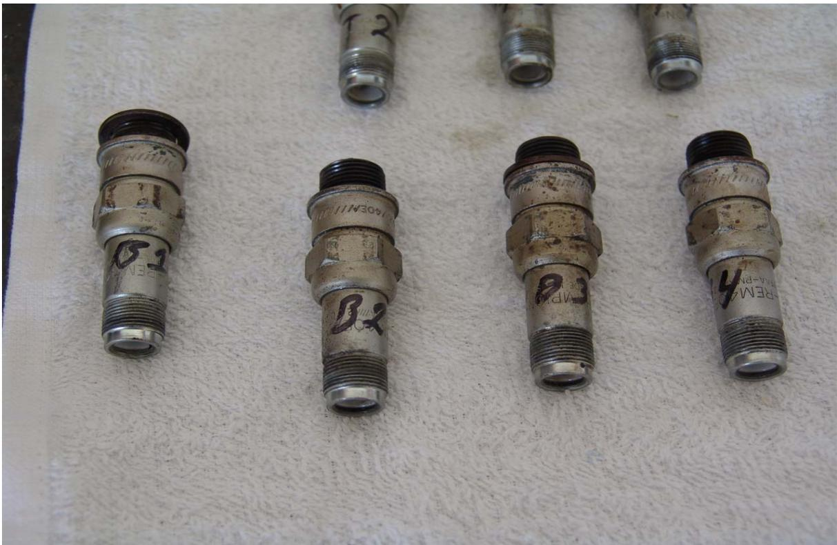
15.- OTRA VISTA DE LAS CONDICIONES DE LAS BUJIAS INFERIORES, APRECIANDOSE EN CONDICIÓN NORMAL.
