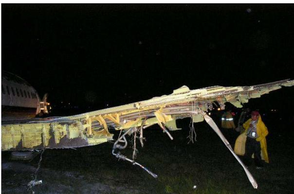
**Figura 39.- Ala destruida por impactos (aeronave comercial reactor), se aprecia la deformación de esta sección.**
