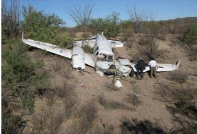
**Figura 37.-** Daño en la sección central del fuselaje de una aeronave bimotor, con exceso de velocidad, al salir de la pista en el aterrizaje.
