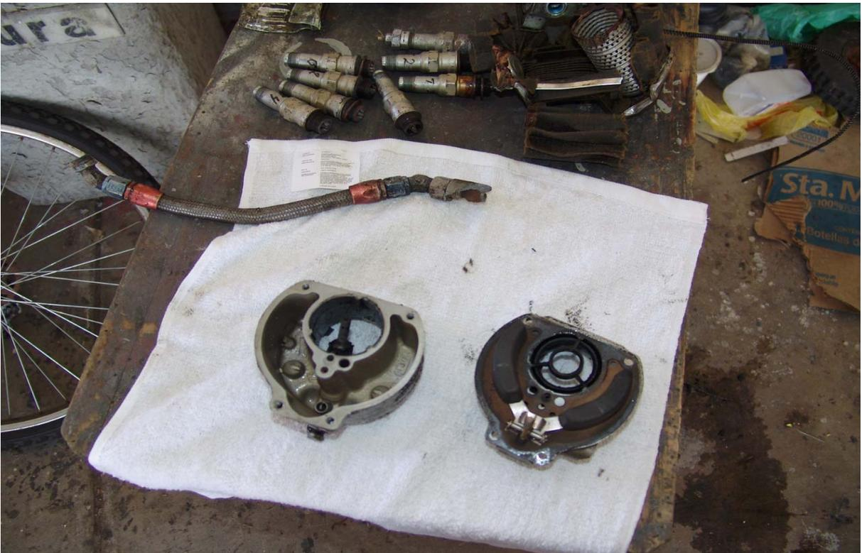
22.- CONDICIONES FINALES DEL CARBURADOR DEL MOTOR, APRECIANDOSE ESTE ABIERTO, SIN APARENTES DAÑOS.
