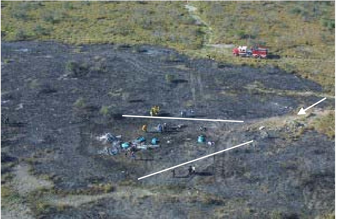
**Figura 26.-** En esta vista aérea se muestra el lugar del impacto y la trayectoria de dispersión de los restos, pero como se observa esta no tenía velocidad de desplazamiento, si no fuerza vertical, es decir desplome, por esto los restos no se diseminaron sobre la trayectoria, sino en un punto específico incendiándose.
