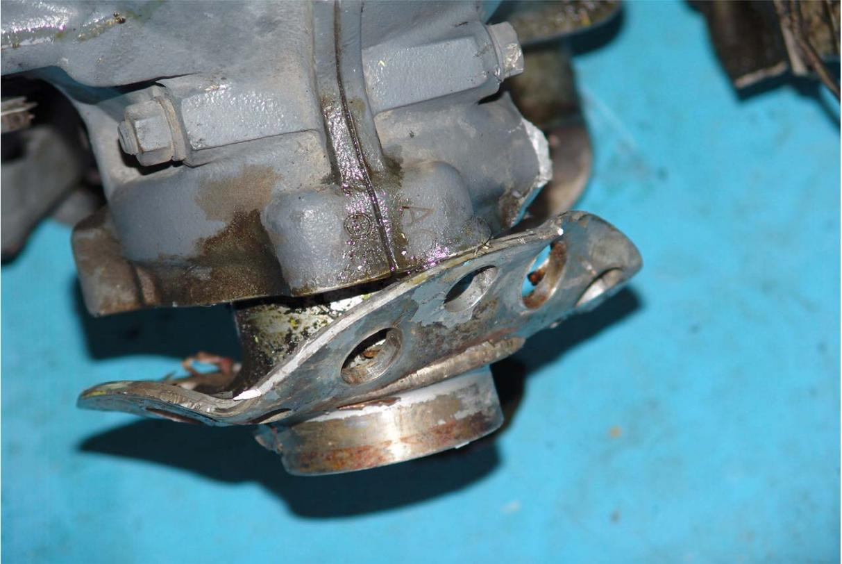
21.- ACERCAMIENTO AL ACOPLAMIENTO DE LA HELICE CON LA FLECHA DEL MOTOR, APRECIANDOSE EL DAÑO AL IMPACTAR CONTRA EL TERRENO.
