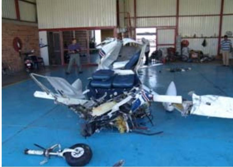
**Figura 43.-** Imagen en la que se aprecia la pierna de nariz desprendida, pero intacta a pesar del impacto de la aeronave contra el terreno, con esta sección.
