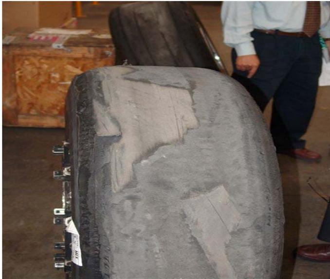
**Figura 66.-** Desprendimiento de la banda de rodamiento o piso del neumático.
