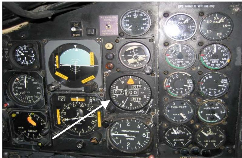
**Figura 52.-** Se aprecia que el altímetro tiene activada una de las banderas amarillas, la cual se señala con la flecha, esto indica que el instrumento esta inoperativo, este sistema trabaja por medio del pitot, como se aprecia marca 7600 pies cuando debería estar a 1300 pies.
