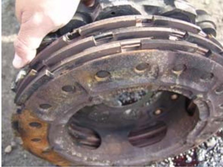
**Figura 51.-** Conjunto de discos de frenos de una llanta con un uso normal.
