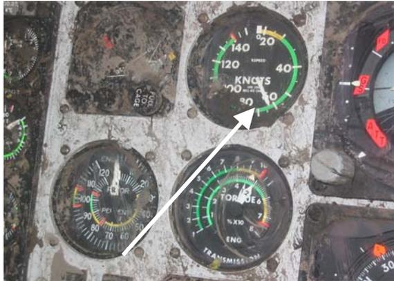
**Figura 53.-** En este caso el instrumento se quedo trabado en una indicación, por lo que se comparo con el indicador de potencia de los motores
