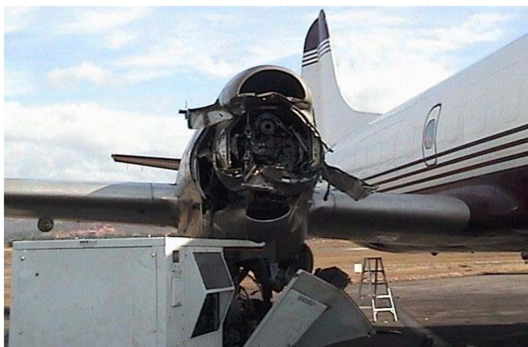
**Figura 11.-** Se aprecia como la hélice impacta contra una planta con potencia resultando severamente dañada esta sección.
