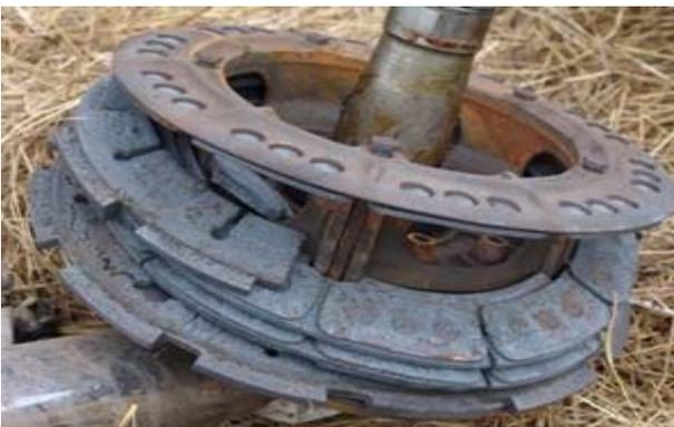
**Figura 50.-** Conjunto de discos del sistema de frenos, los cuales constantemente se utilizaban con velocidad, provocando esto que se pongan azules e incluso se ven cristalizados, esto posiblemente al enfriarlos con agua.
