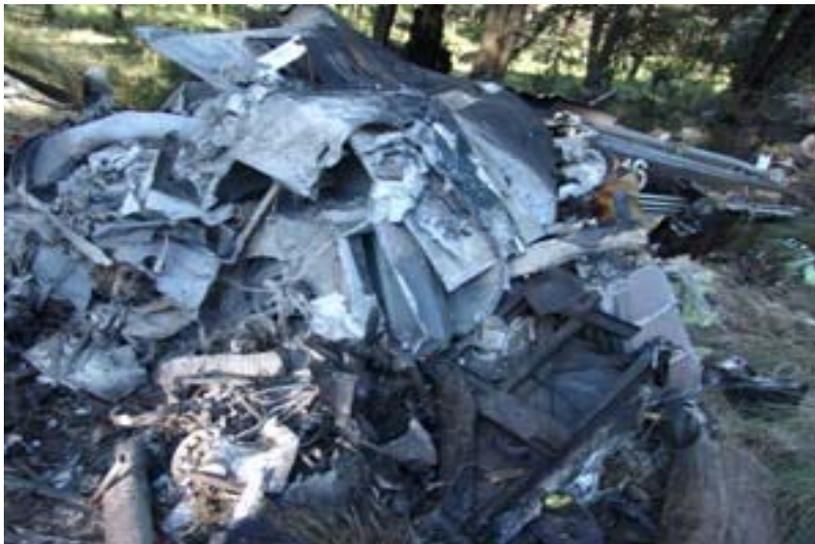
**Figura 38.-** Destrucción del cuerpo básico (sección central del helicóptero), por impactar contra el terreno, caso CFIT.
