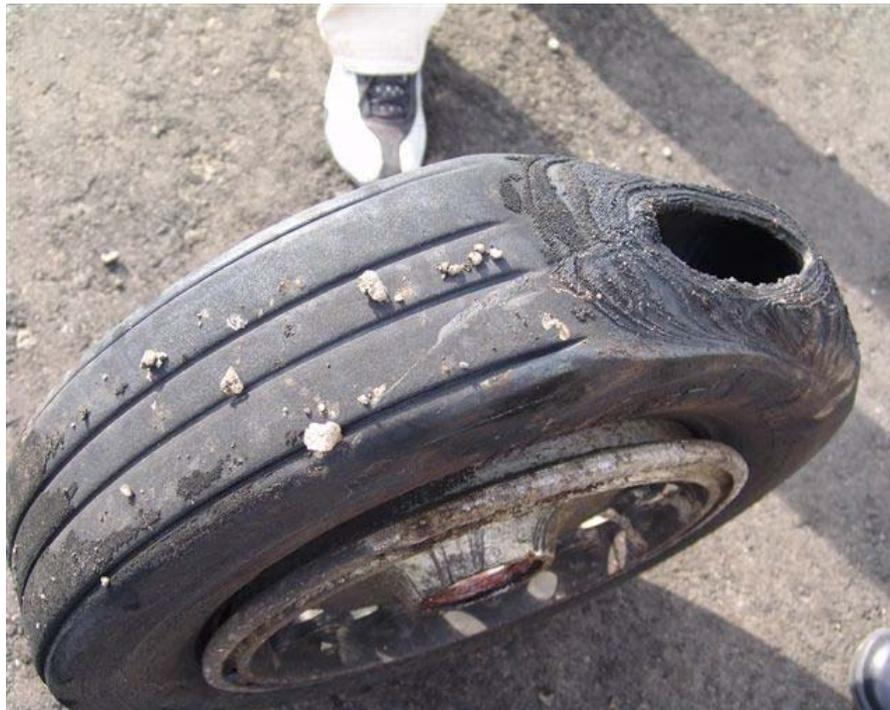
**Figura 67-** Estallamiento del neumático por uso excesivo de frenos.
