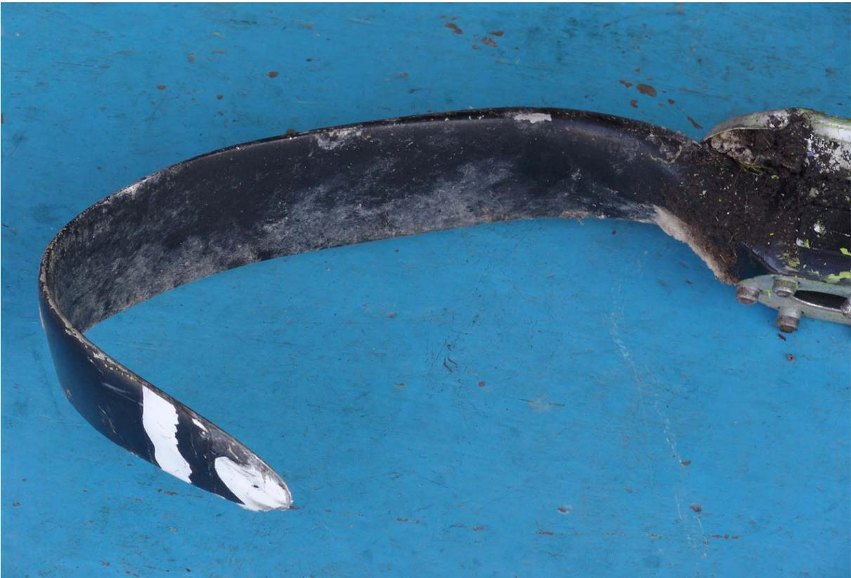
30.- ACERCAMIENTO A UNA DE LAS PALAS DE LA HELICE, DONDE SE APRECIA LAS CONDICIONES FINALES DE ESTA, AL IMPACTAR CONTRA EL TERRENO.
