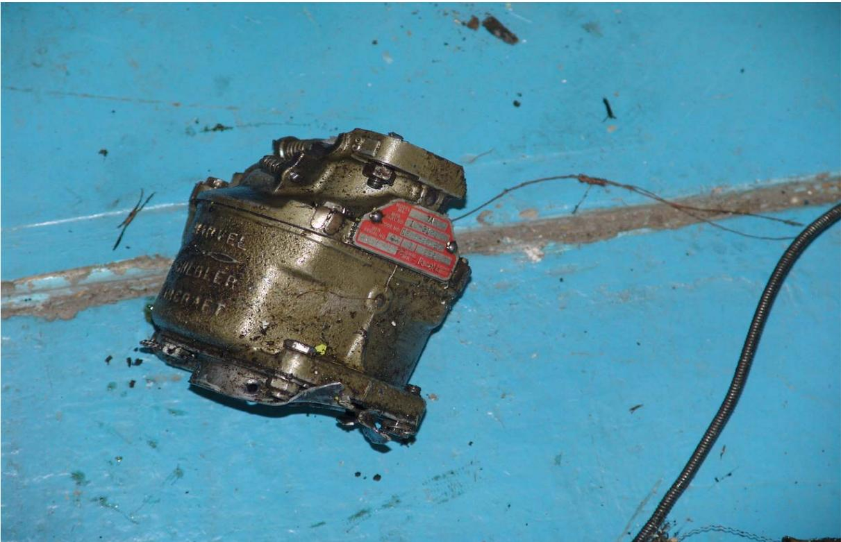
8.- VISTA GENERAL DE LAS CONDICIONES FINALES DE LA BOMBA DE SUCCIÓN DEL MOTOR, DESPRENDIDA DE SU POSICION.
