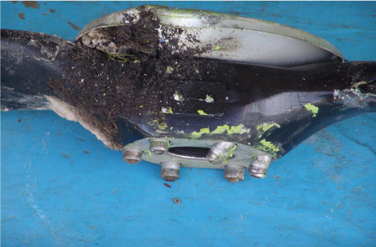
31.- ACERCAMIENTO AL NUCLEO, DONDE SE APRECIA LAS CONDICIONES FINALES DE LOS PERNOS QUE LA SUJETABAN AL MOTOR.
