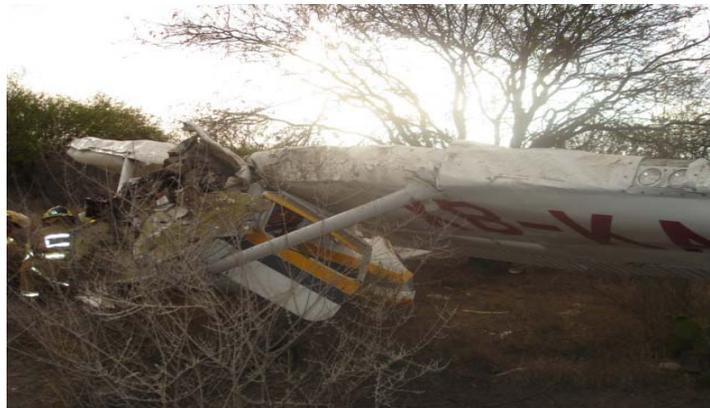
**Figura 18.-** Se aprecia el daño en el fuselaje por un aterrizaje brusco.
