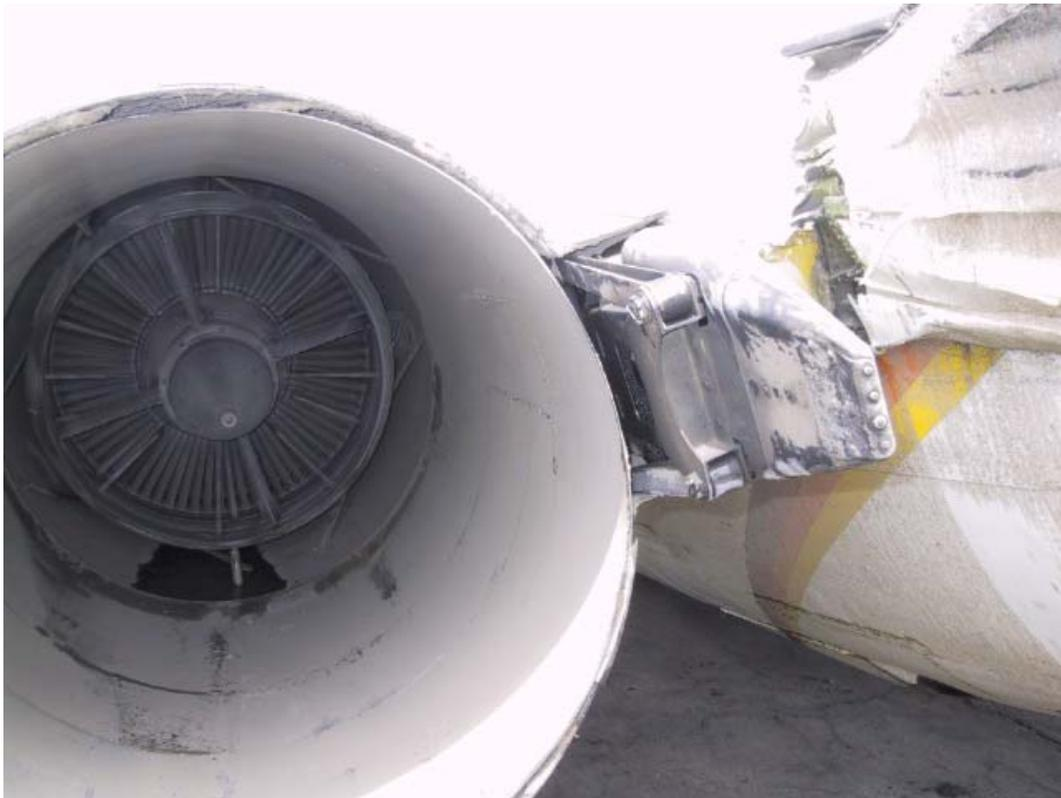
**Figura 48.-** Se aprecia como el motor reactor se está colgando de su empotre con el fuselaje y este como está semidesprendido de su posición.
