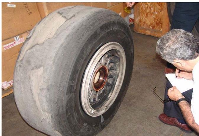
**Figura 14.-** Foto en la que se muestra el típico desprendimiento del piso de un neumático, esto se puede dar por diversas condiciones, ver tabla de daños.
