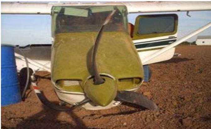
**Figura 27.-** Se observa los daños no severos de la hélice, indicando que estaba girando a bajas revoluciones.
