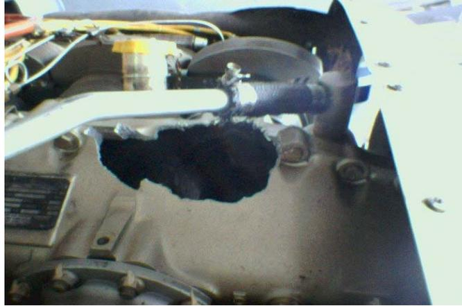
**Figura 9.-** Tipo daño estructural interno de un motor generando la destrucción de un monoblock o de algún otro componente o parte de este.
