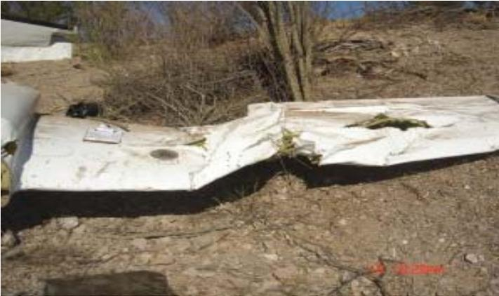
**Figura 40.- Ala destruida por diversos impactos, aeronave bimotor (pistón) velocidad baja.**
