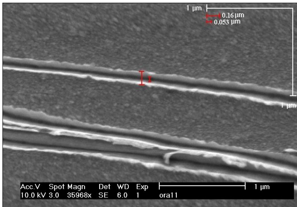
Figura 3.15: Rayado con el microscopio de fuerza atómica y escaneado con el microscopio electrónico de barrido.
