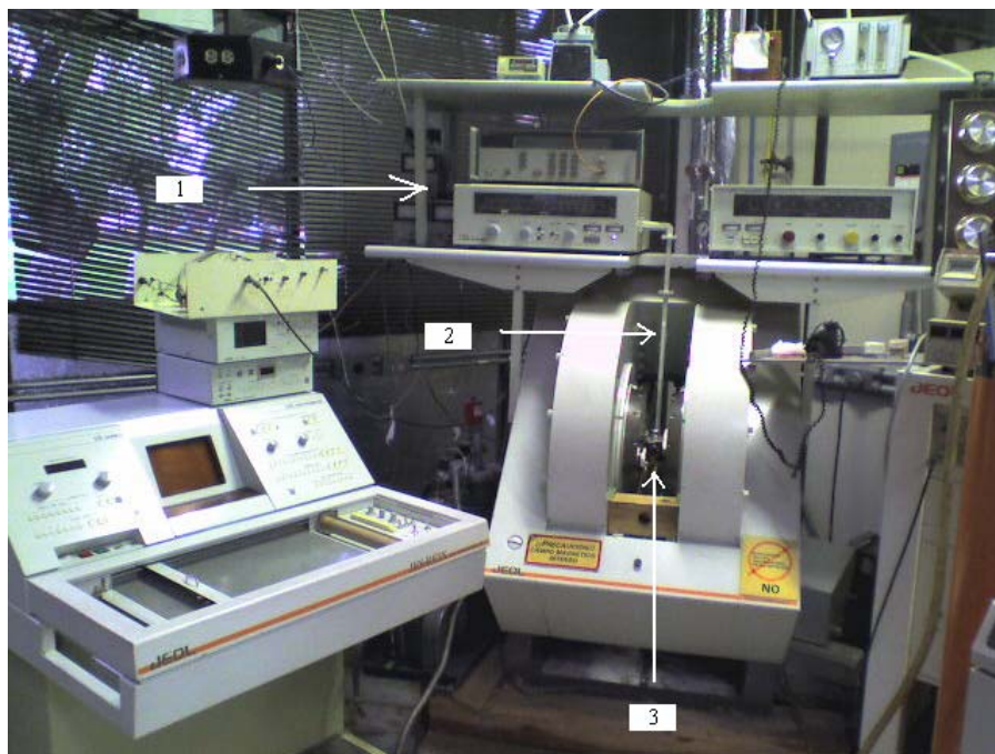
Figura 2.8 Espectrómetro de Resonancia Paramagnética empleado en las mediciones de FMR y LFA.
