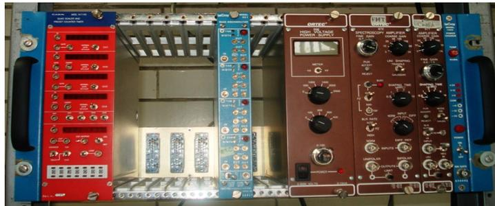
***Fotografía 8. NIM (Nuclear Instrument Module)***
