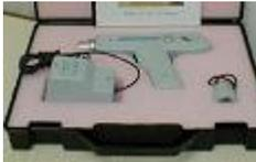
Es un instrumento ampliamente utilizado para la terapia con láser infrarrojo que emplea un diodo láser pulsado de Arseniuro de Galio (GaAs) con longitudes de onda de 904 nm y potencia media de 7 mW. Se aplica en tratamientos de fototerapia y reflexoterapia, en condiciones de hospitalización y en pacientes ambulatorios. Contiene un adaptador para la comprobación del emisor láser.
