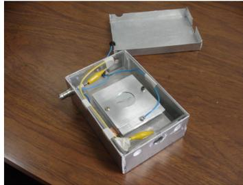
**Fotografía 11. Cámara de ionización.**
