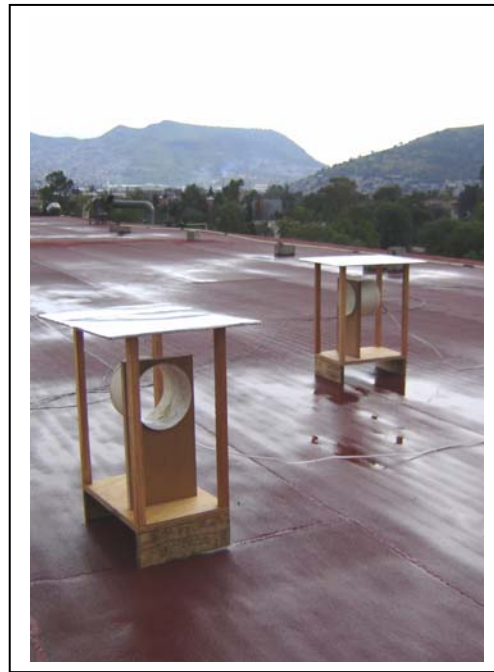
Fig. 3.9.- En la foto se muestran las 2 bobinas orientadas perpendicularmente.
