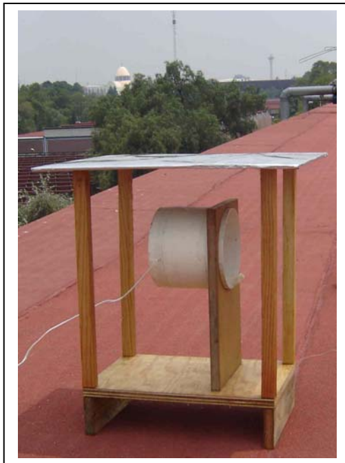
Fig. 3.8.- Forma como se instalaron las bobinas en el techo del edificio Z.
