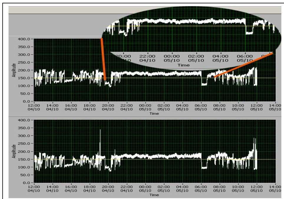
Fig. 5.4. Corrida de 24 hrs. Indicando el intervalo de 22:00 a 6:00 donde se estabiliza el espectro correspondiente a la banda 1 de la bobina N-S
