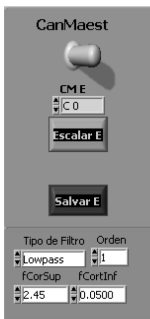
Fig.4.5.- Dispositivo virtual para seleccionar el canal en función del cual se analizarán todos los demás, el tipo de filtro, las frecuencias de corte y el orden del filtro digital.
