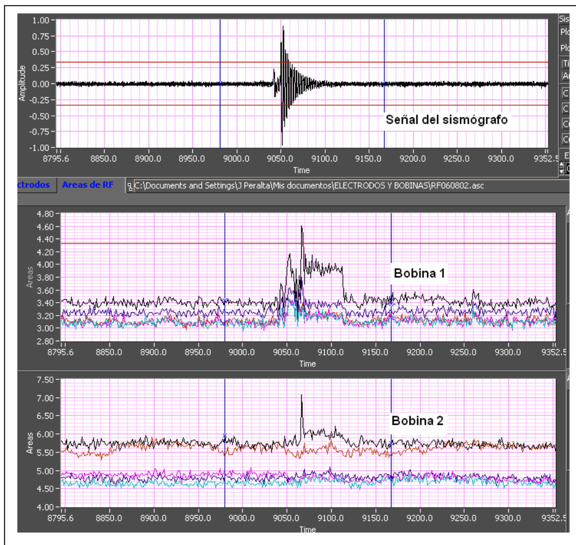
Fig. 6.6.- Panel virtual del programa que muestra simultáneamente la señal sísmica artificial con las señales de radiofrecuencia en 2 de las bobinas también inducidas artificialmente
