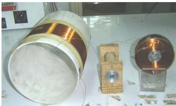
Fig 3.1. Tipo de bobinas construidas.
