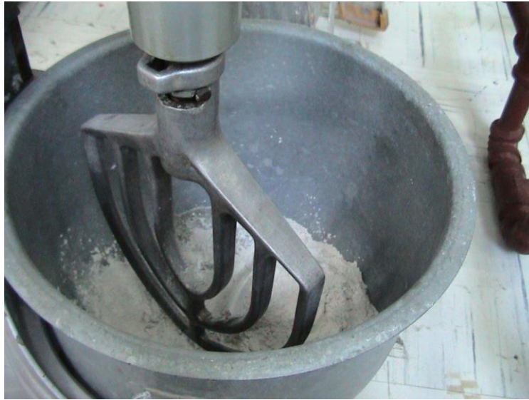
Fig. 3.20 Preparación de la mezcla
