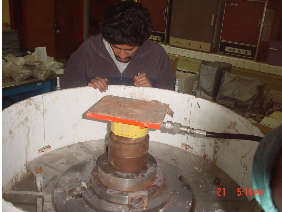
Fig. 3.18 Colocación del gato hidráulico, antes de situar la tapa reforzada
