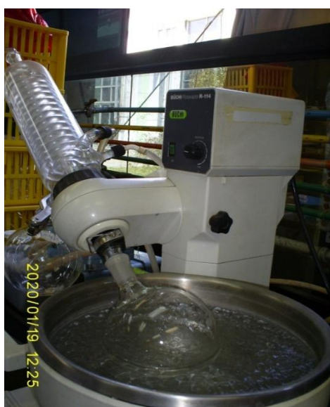
Figura 4.8. Recuperación y purificación del endosulfán en un equipo Rotavapor
