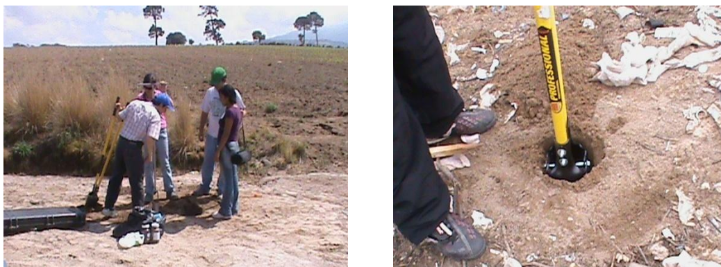
Figura 4.4. Extracción de muestras de suelo en Ayahualulco
