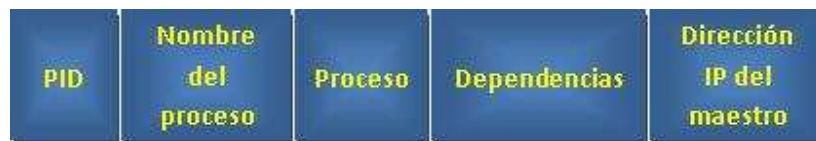
Figura 3.6. Estructura del contenedor unitario de proceso.
