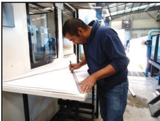
Figura IV.11. Trazo del escantillón (A) y trazo en la pared de acrílico para el rompeolas superficial (B)
