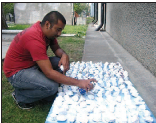
Figura IV.9. Rehabilitación de roca de coraza para franja azul y blanca.
