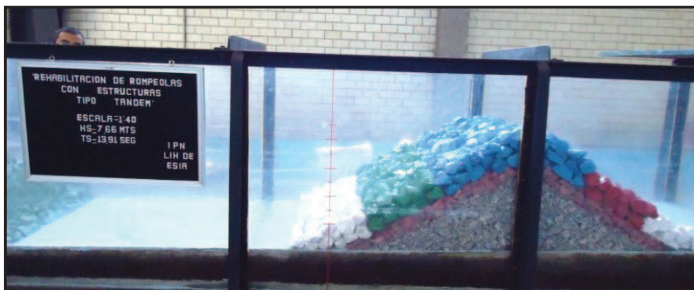
Figura IV.14. Rompeolas superficial finalizado
