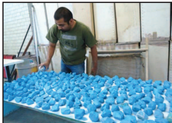
Figura IV.9. Rehabilitación de roca de coraza para franja azul y blanca.
