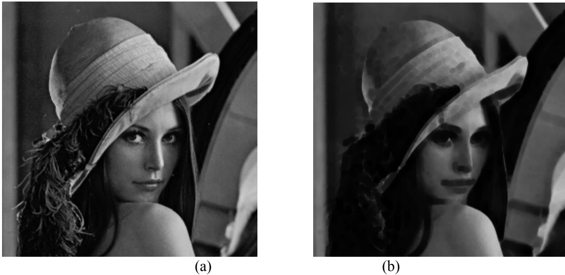
Fig. 3.11 (a) Imagen original. (b) Imagen erosionada con un elemento de estructura circular de 9 píxeles de diámetro y punto de referencia en el centro.
