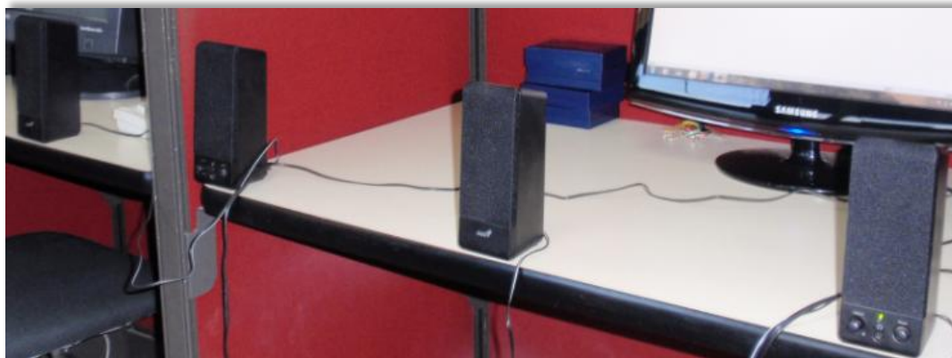
Fig. 5.17 Bocinas utilizadas para simular 2, 3 y 4 fuentes en un cuarto cerrado
