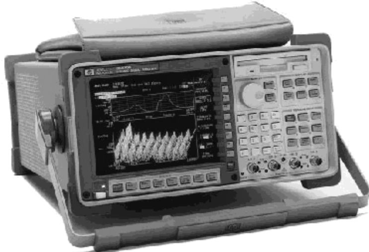
Figura 2.4. Analizador de señal dinámica HP 35670A.
