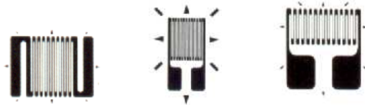
Figura 1. Algunos modelos de strain gages que son utilizados hoy en día.
