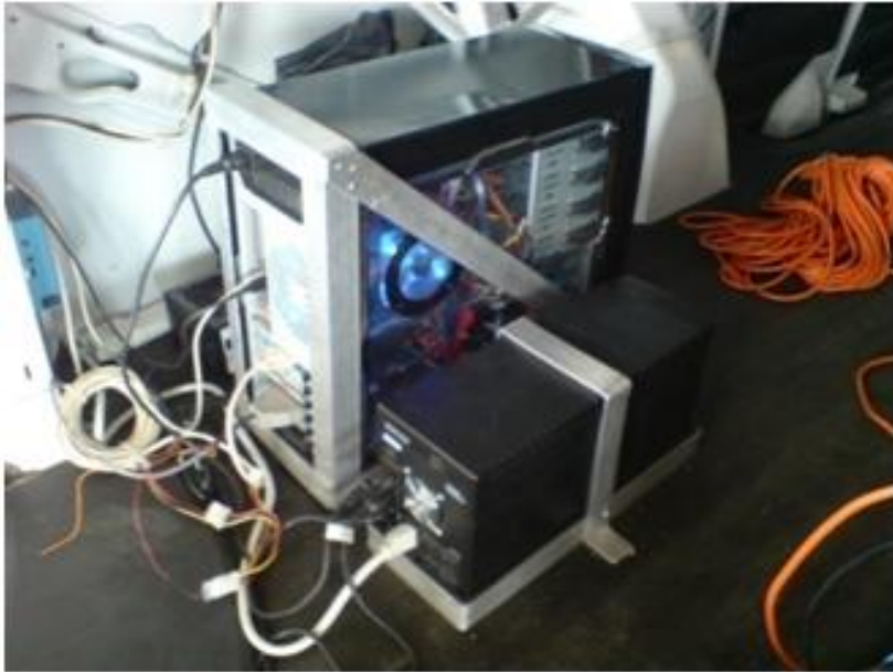
Figura 4. 3 Montaje del CPU y regulador en el interior del vehículo.
