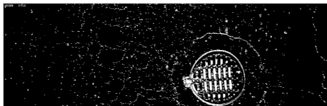
Figura 8. Imagen binaria de la transformada Wavelet aplicada a una imagen con la iluminación corregida.
