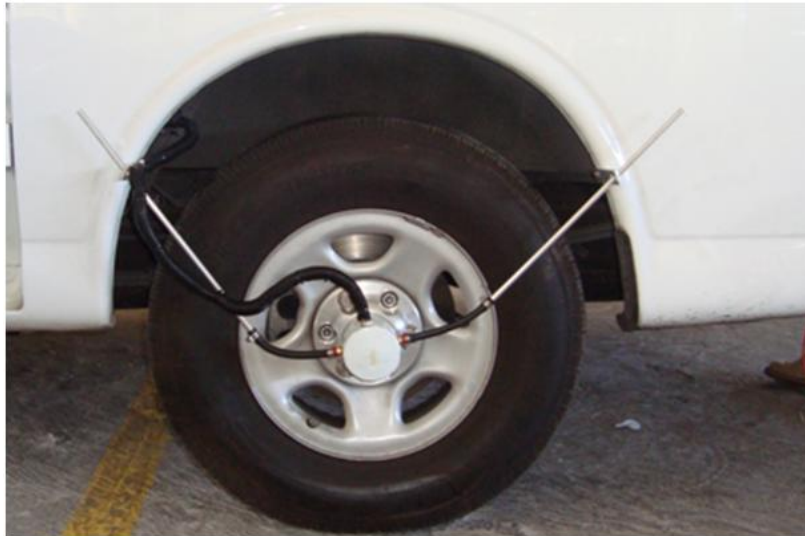
Figura 4. 2 Montaje del encoder en la rueda del vehículo.
