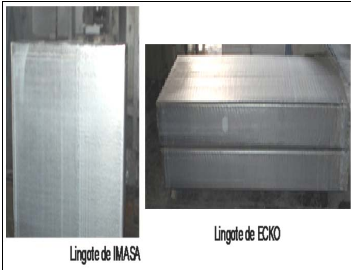
Figura 5.18 Acabado superficial de los lingotes procesados, generados en los experimentos llevados a cabo en IMÁSA y Ecko.
