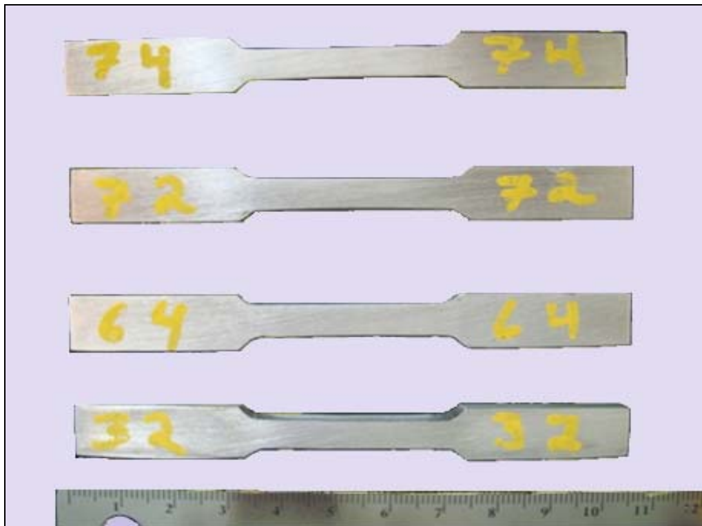
Figura 6.19 Foto de las secciones maquinadas para realizar ensayos de tracción.
