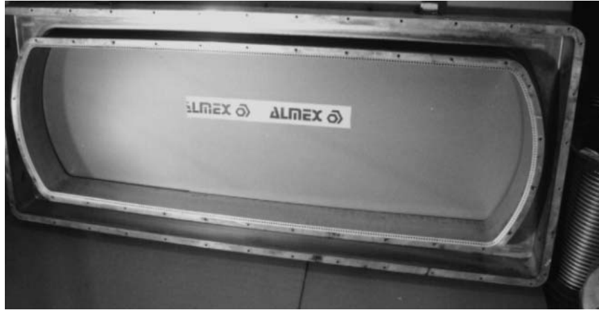
Figura 3.4 Molde compacto para colada semicontinua.
