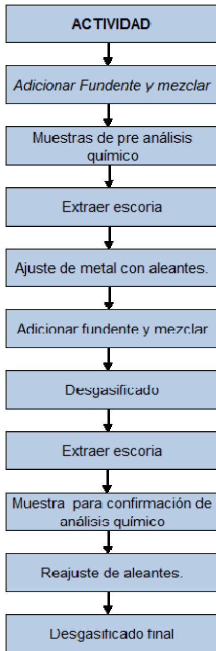
Figura 2.2 Tratamiento de metal liquido.
