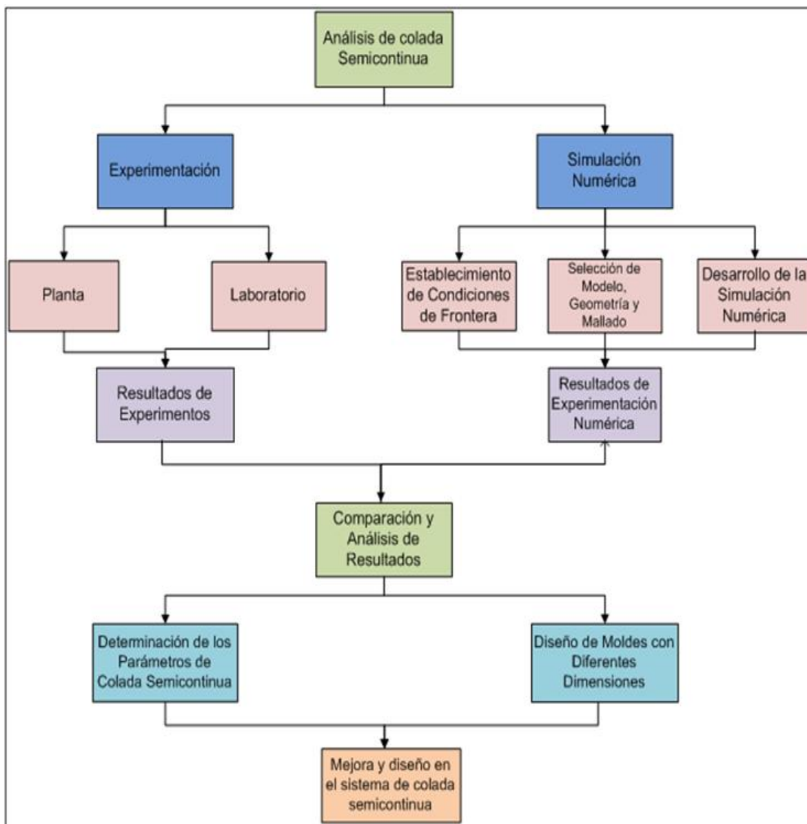
Figura 4.1 Metodología utilizada para analizar el proceso de solidificación durante la colada semicontinua de aleaciones de aluminio.
