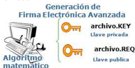
Figura 2.10: Esquema de generación de llave pública y privada. Fuente: www.sat.gob.mx, Marzo de 2011.
