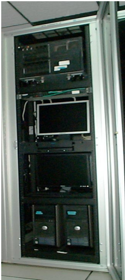
Figura 2.2 Gabinete de 42U. En donde se pueden observar solo 3 servidores y dos pantallas planas. (Fuente Autoría propia)
