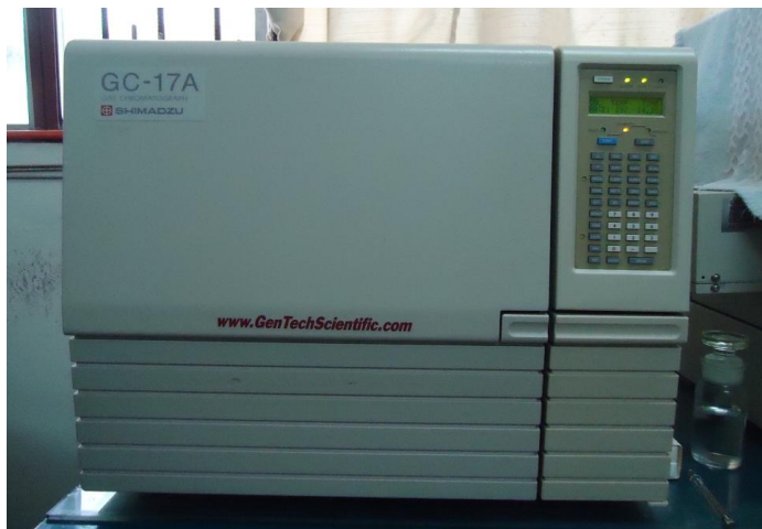
Fig. 12. Cromatógrafo de gases con detector de captura de electrones.
