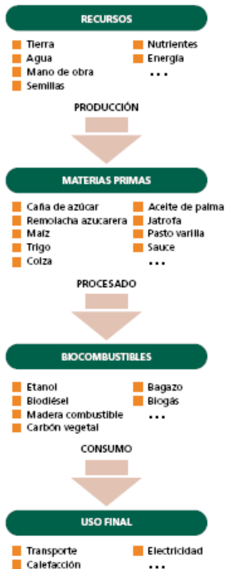
Figura 1. Biocombustibles: desde la materia prima hasta el uso final.
