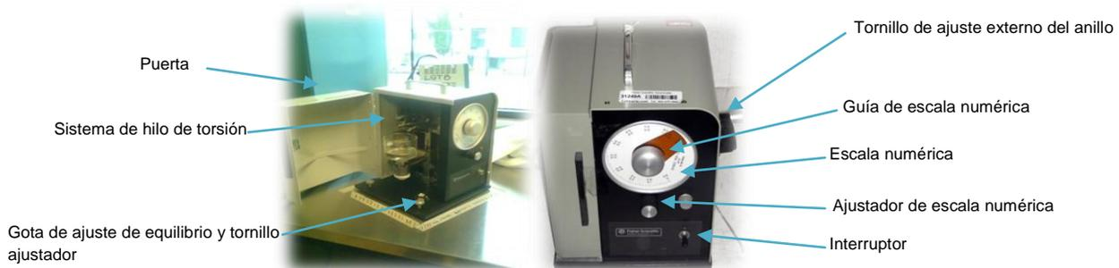
Figura 10-1. Se ilustran las principales partes del tensiómetro de Du Nouy.
