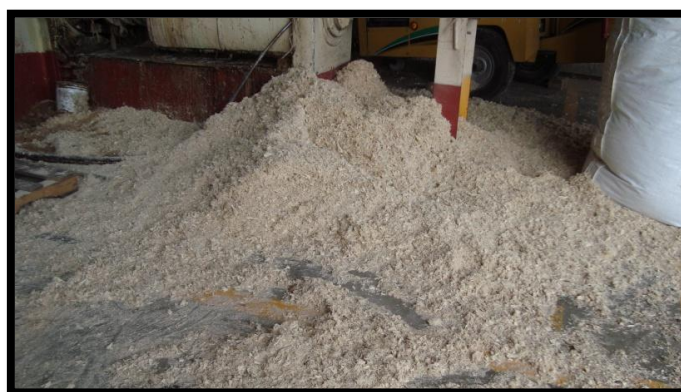
Figura 8. Bagazo en planta, después de salir del proceso de extrusión en frío.
