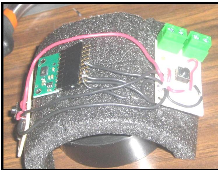
Figura 4.28 Botones situados a los extremos del control de giro
