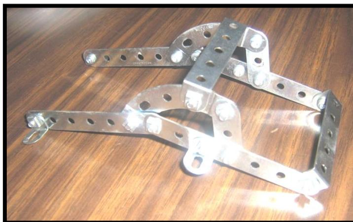
**Figura 4.25 Estructura para montar los sensores infrarrojos**
