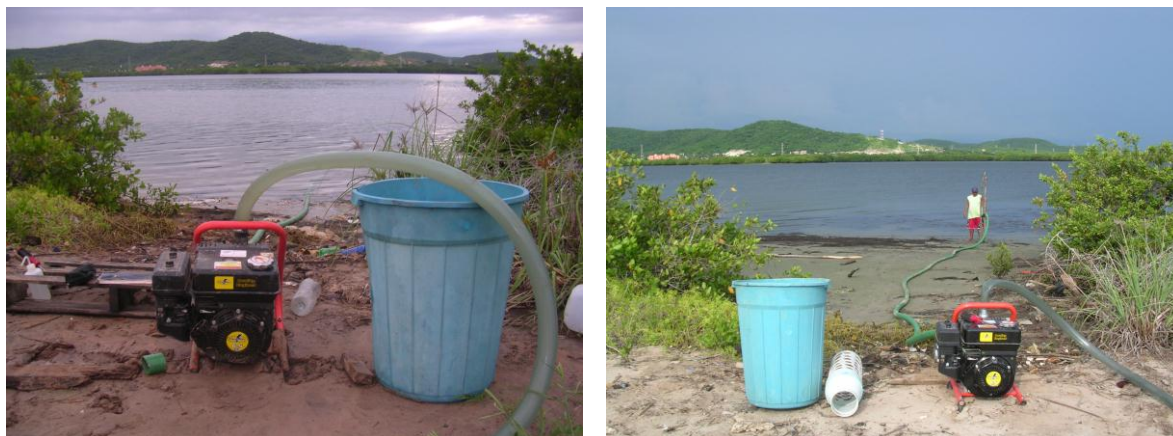
Figuras 2 y 3. Estación de bombeo de agua para los estanques del humedal artificial.
