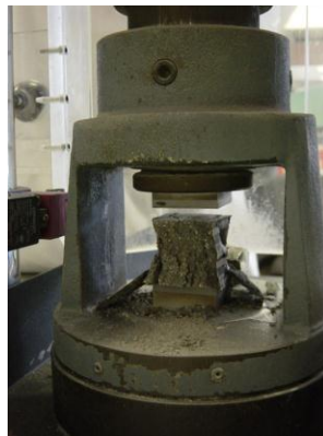
Figura 1.5.- Probeta cubica ensayada a compresión.
