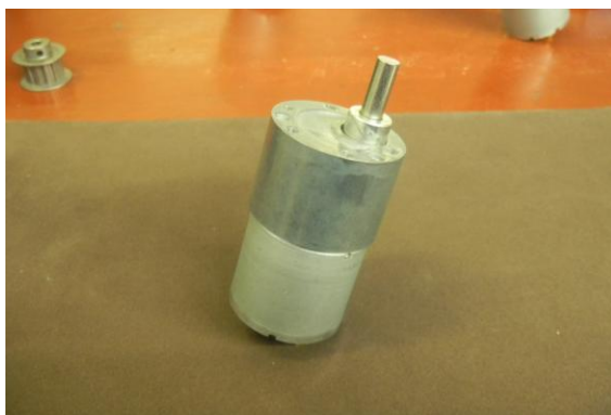
Fig. 4.11. Motores y engranes empleados en las articulaciones 2, 3 y 4
