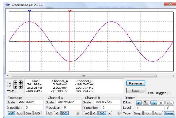
Figura 6.2: Señal de Entrada con Frecuencia a 1 mHz
