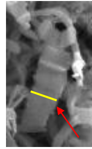
Amplificación de un listón de grafito con un ancho de aproximadamente 375 nm.
