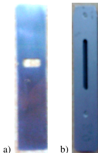
Figura 2.5. a) Rendija para la divergencia axial, b) Rendija para la divergencia ecuatorial
