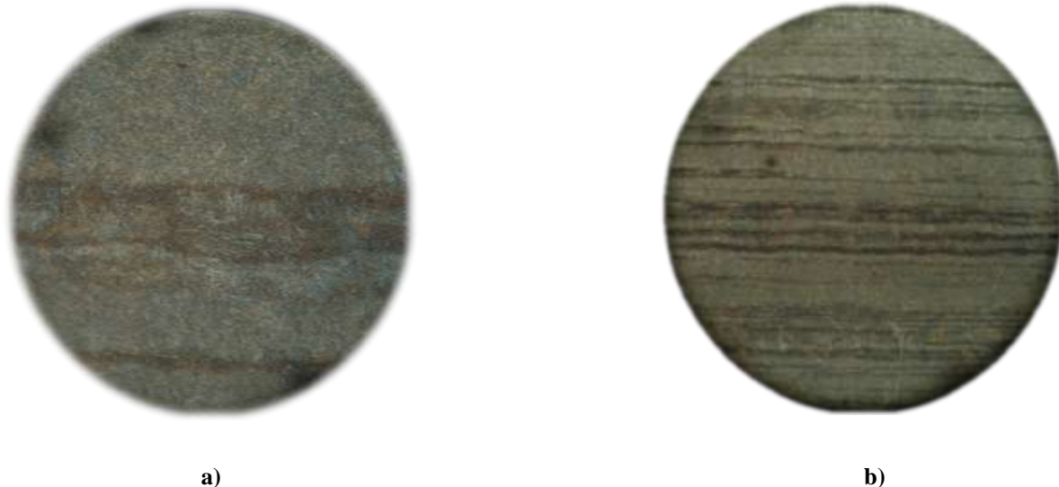
Fig. 21. Fotomicrografías a 500 y 100X del acero 32CrMoV12-10: a) Martensita revenida, 500X, b) Presencia de bandeado, 100X
