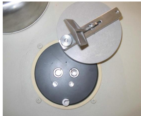
Figura 2.3 Vista superior del Calorímetro DSC 7. Se observan las celdas de referencia y de la muestra
