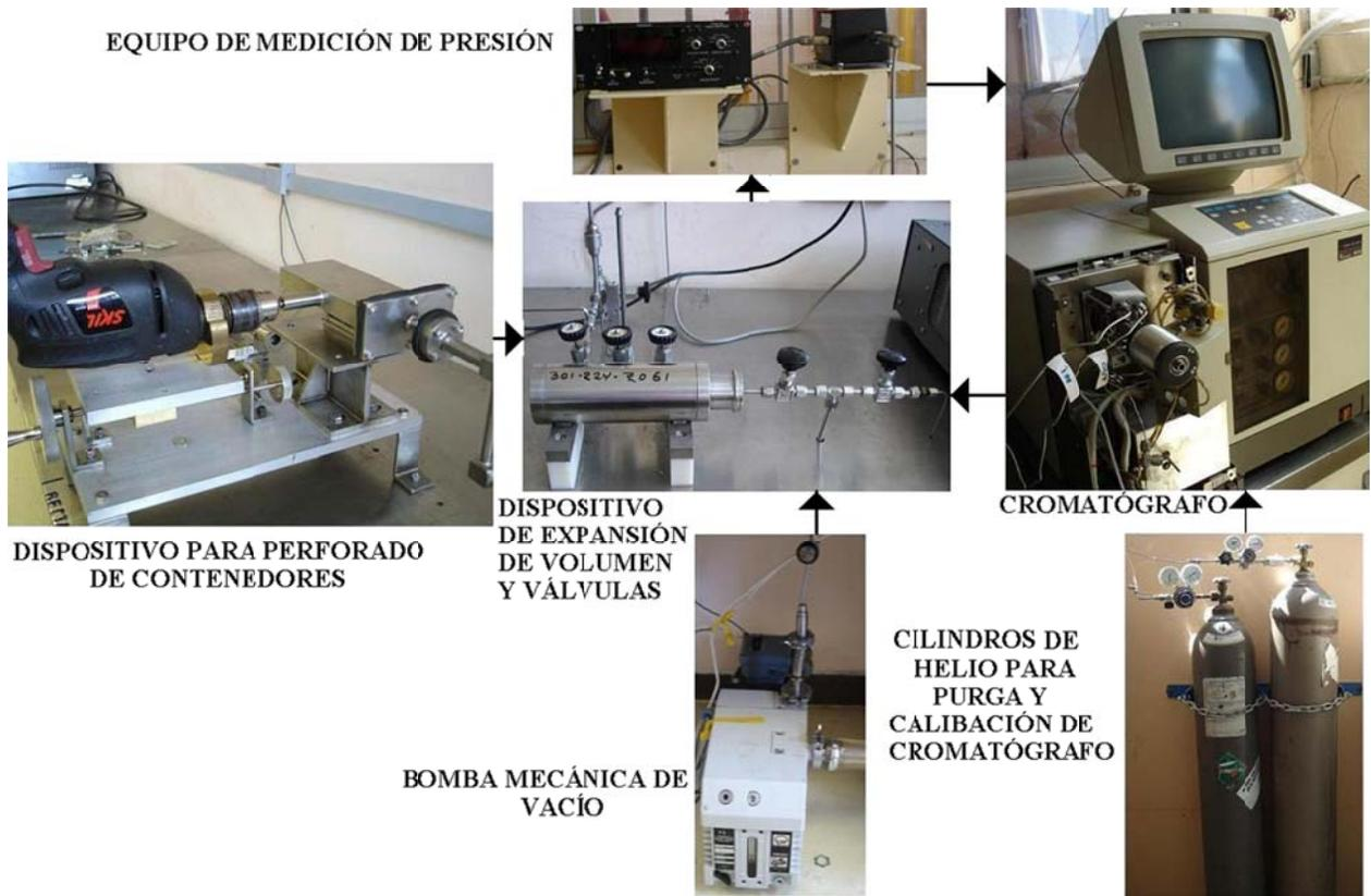
Figura 3.34.- Sistema de inspección de presión interna de helio en los contenedores y pureza del Helio
