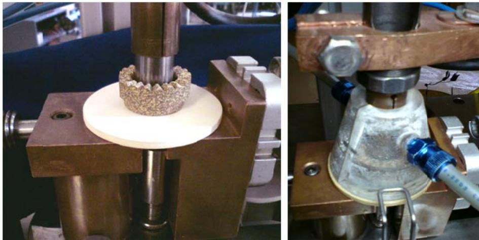
Figura 3.3.- Cerámicos usados y dispositivo de flujo.
