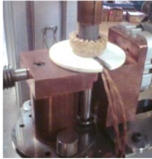
Figura 3.23.- Vista de los Termopares Montados para el Proceso de Soldadura
