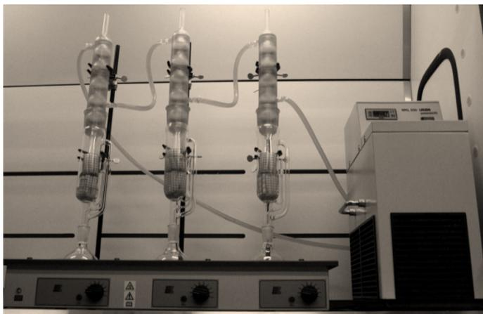
**Figura 4.** Aparato de Soxhlet usado para la extracción de lípidos de las muestras de presas potenciales y piel de *Chelonia mydas*.
