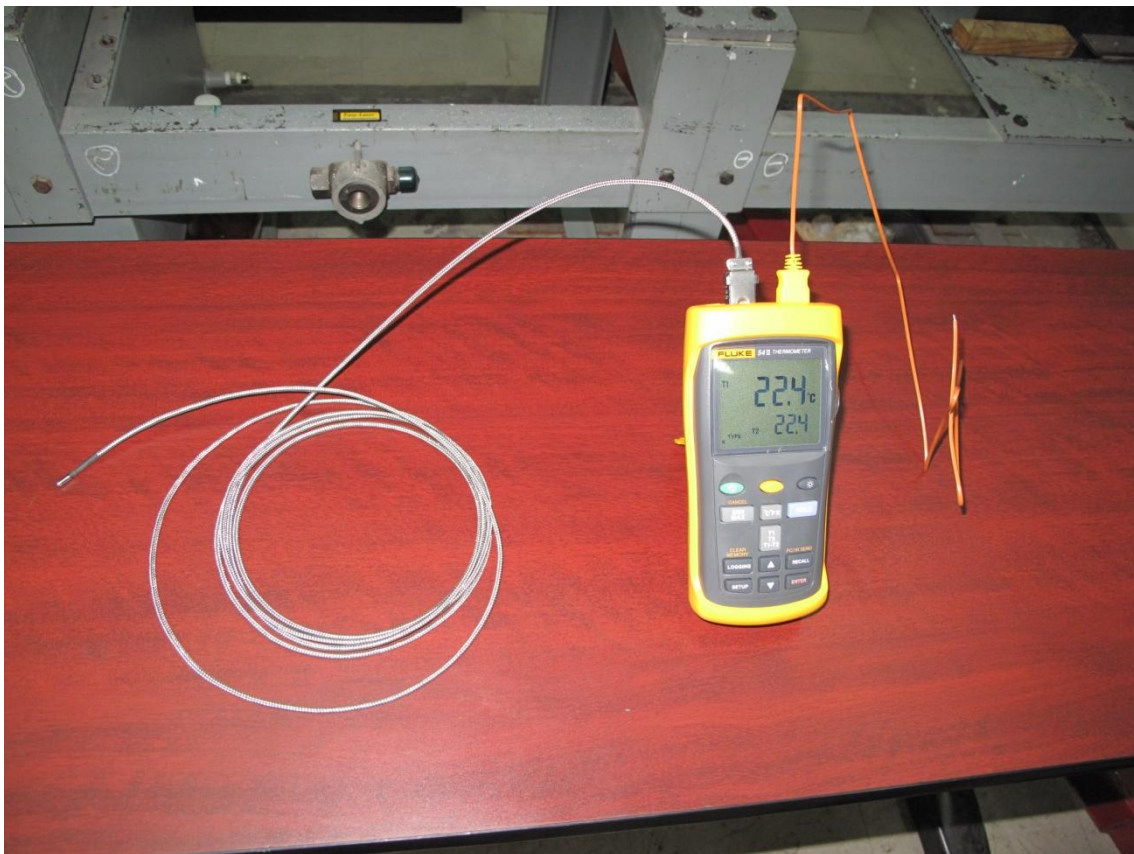
Imagen 4- 42: comprobación de temperatura de los termopares
