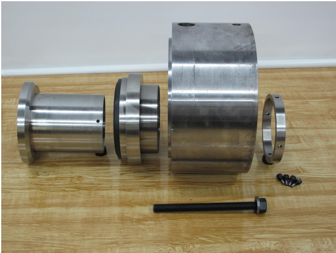
Imagen 4- 23: orden en el cual deben ser colocados los componentes del sello mecánico (vista lateral)
