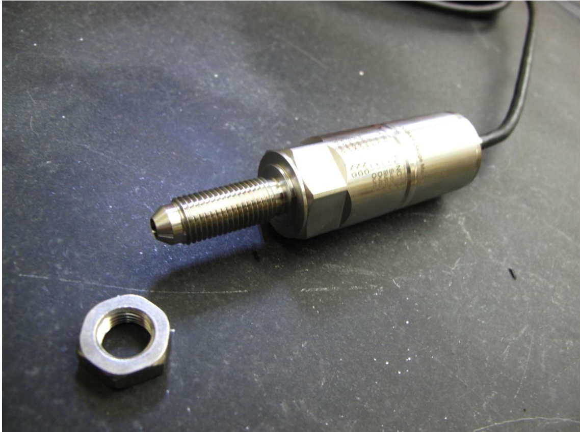
Imagen 4- 60: sensor de presión KISTLER 4260A (con un rango de medición de 0 a 100 BAR)
