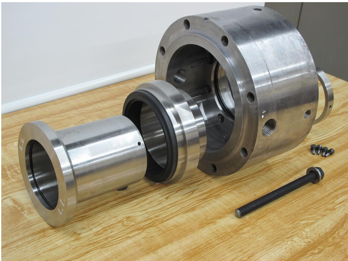
Imagen 4- 24: orden en el cual deben ser colocados los componentes del sello mecánico (vista frontal)
