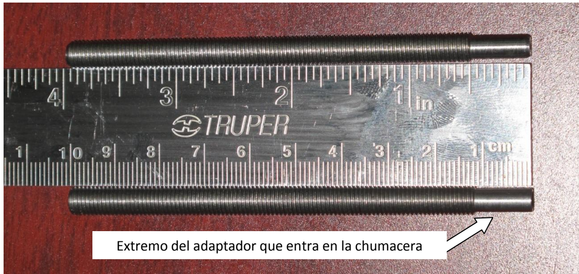
Imagen 4- 45: adaptador para sensar presión
