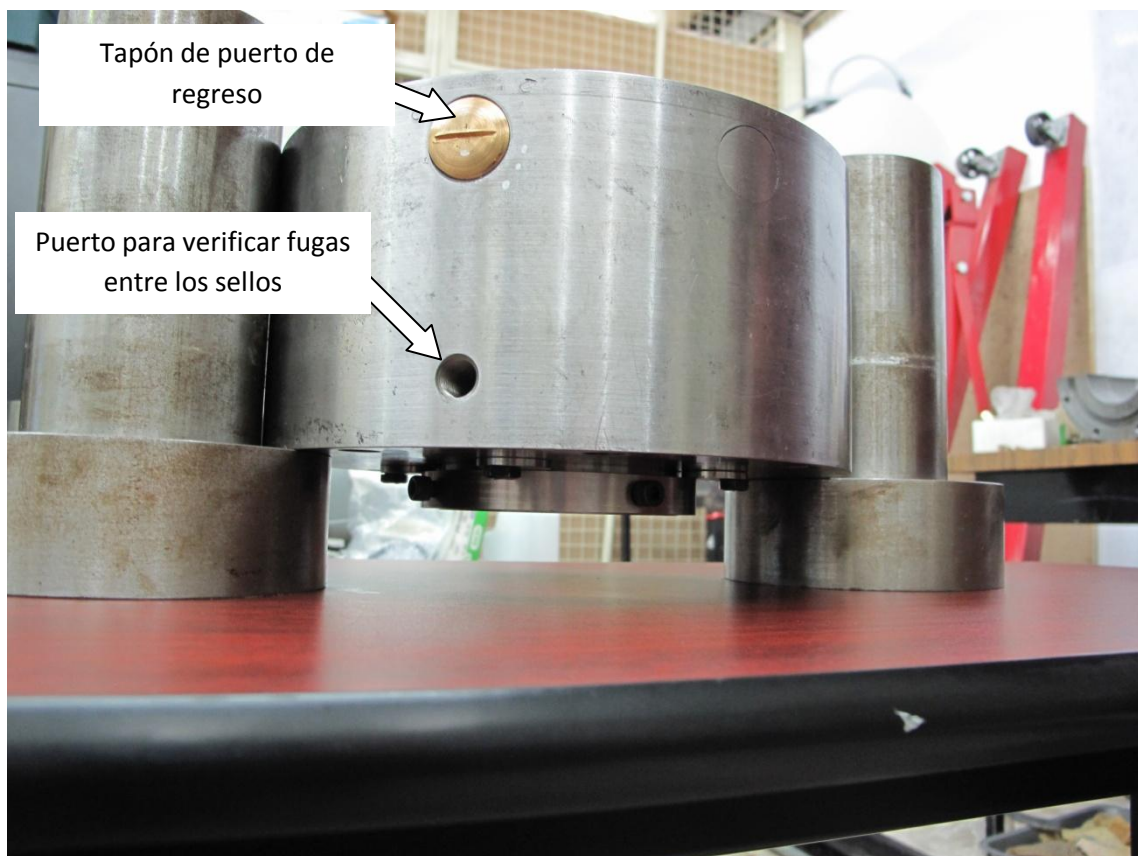
Imagen 4- 28: sello mecánico sobre una base para revisar posibles fugas (vista lateral)
