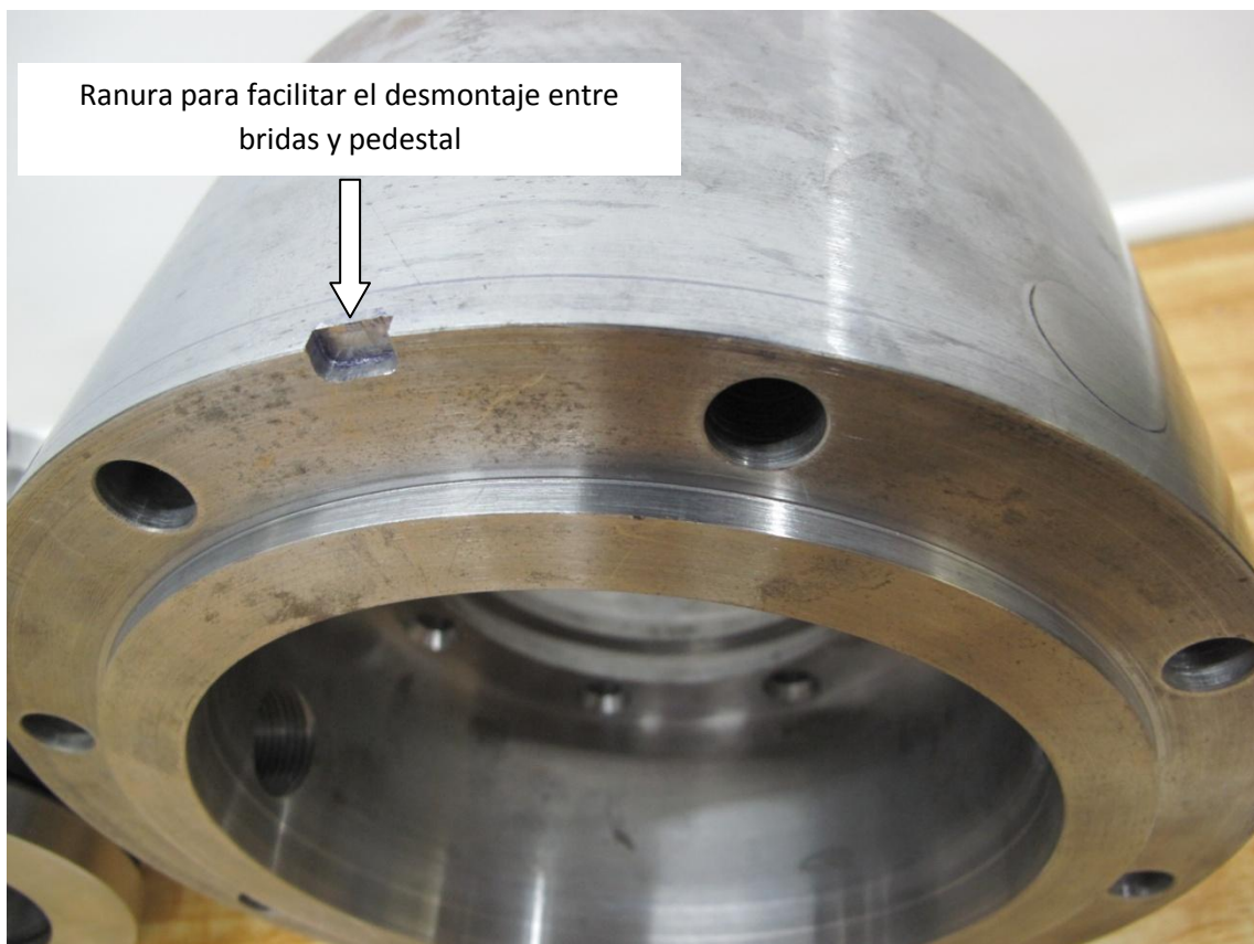
Imagen 4- 15: ranura de desmontaje en la brida de sello
