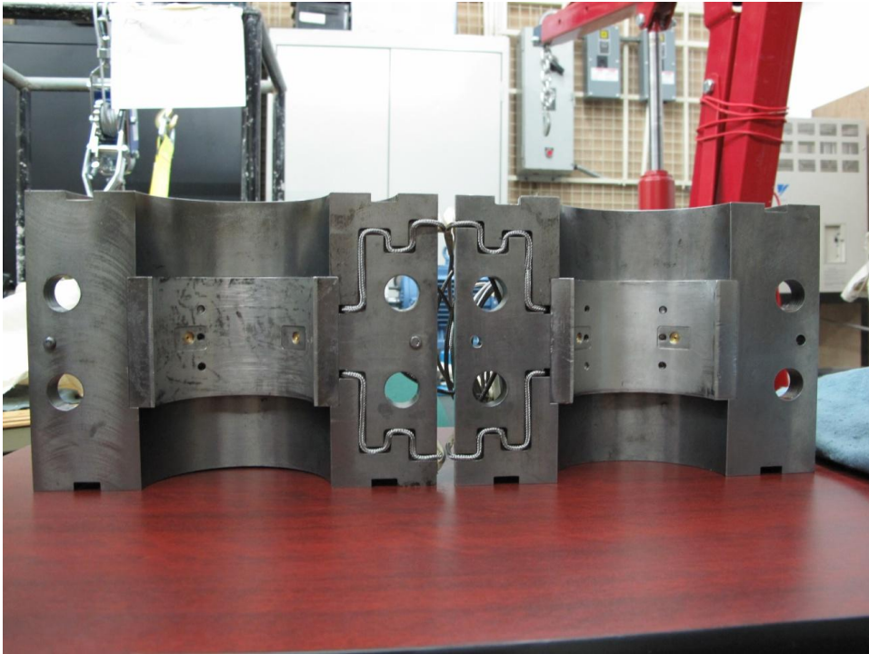
Imagen 4- 49: chumacera inferior (izquierda), chumacera superior (derecha) en pedestal con sus adaptadores, tapones y capilares
