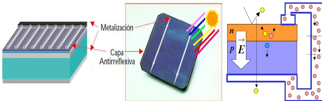
Figura II.1.- Representación Física del efecto fotovoltaico en una celda solar [21].
