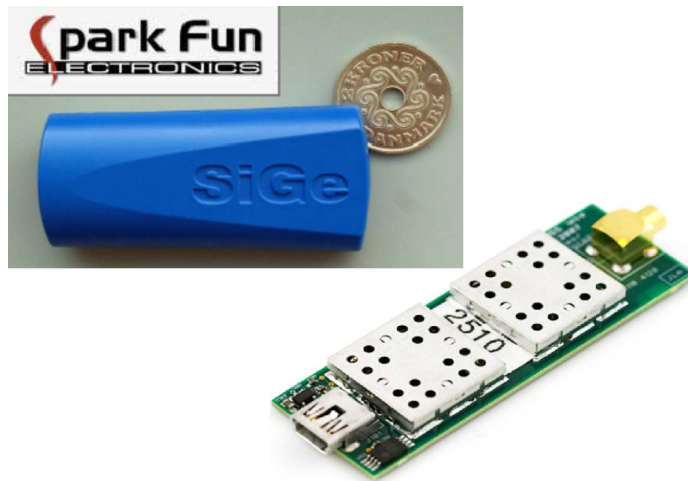
Figura 4.4: Front-end SiGe 4120 GPS ASIC. Cortesía de Xilinx.
